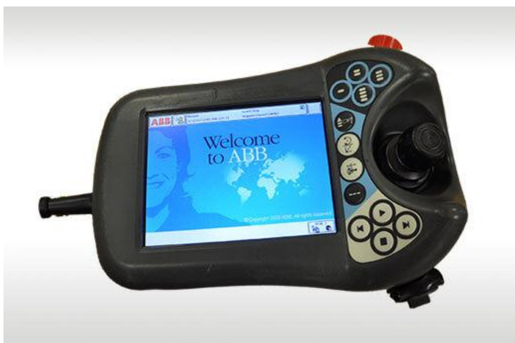
Slika 53. ABB privjesak za učenje – IRC5 kontroler
