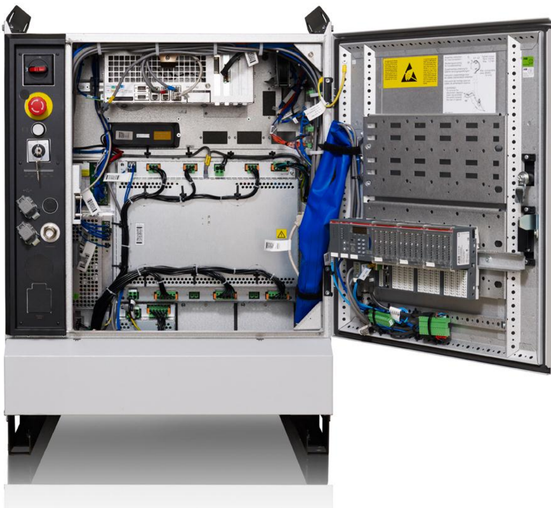
Slika 61. Upravljački ormar IRC5
