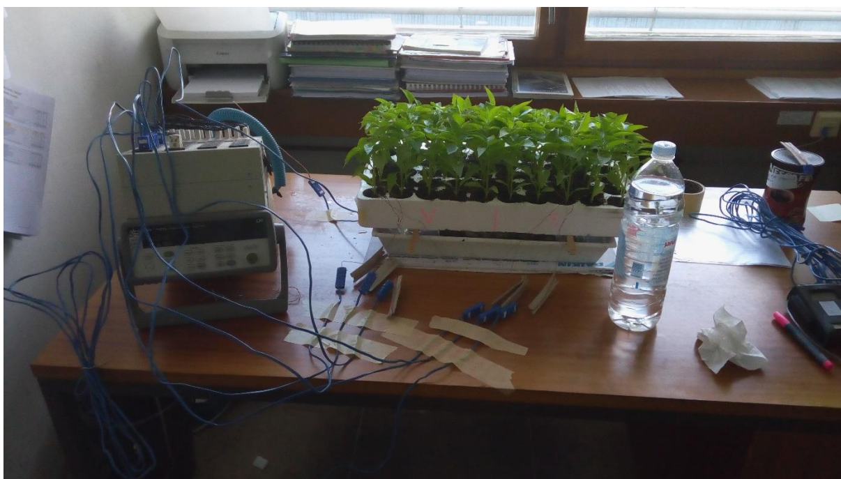
Slika 21. Postavljanje termoparova u uzorke
