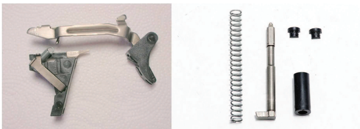
Slika 19. Elementi sklopa okidača te sklopa udarne igle
