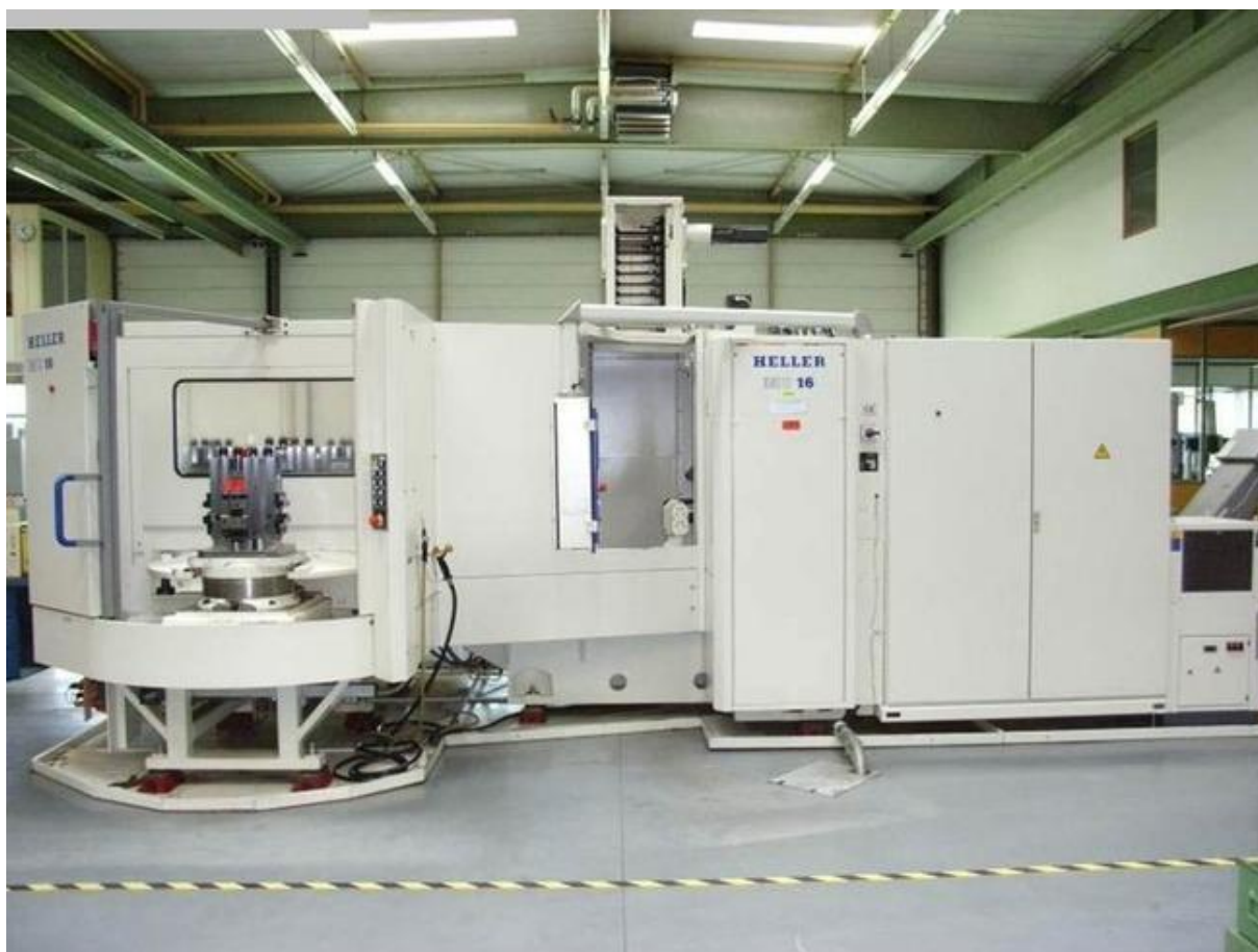
Slika 9. Horizontalni obradni centar „HELLER MC16“
