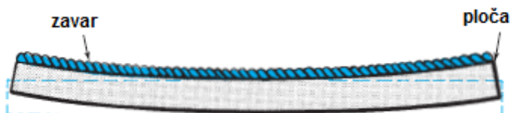
Slika 8. Shematski prikaz savijanja [7]
