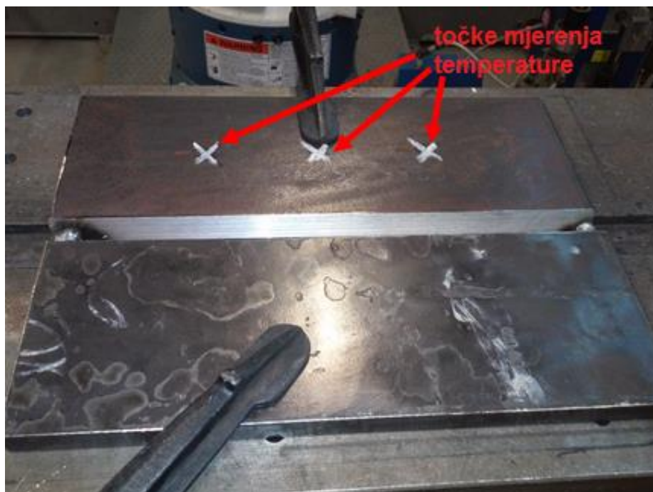
Slika 35. Spoj 1 pripremljen za zavarivanje
