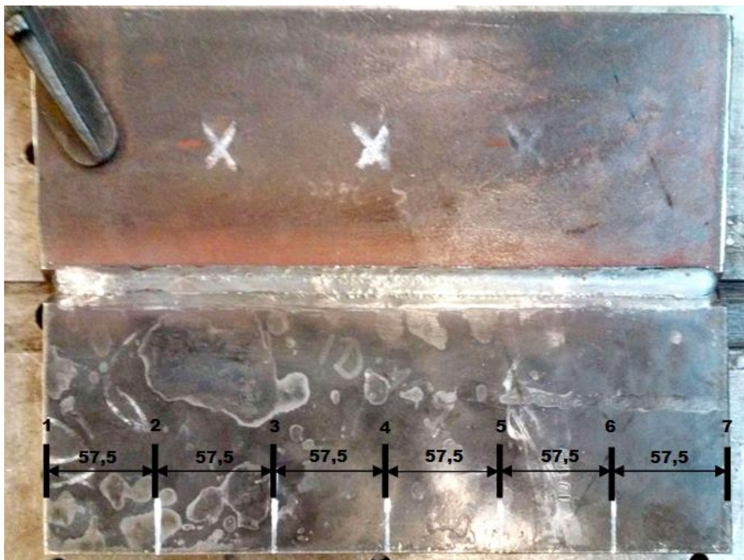
Slika 47. Točke mjerenja deformacija
