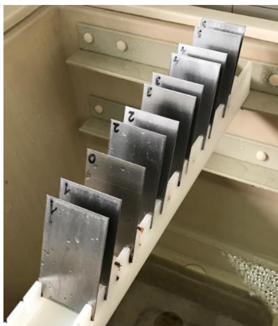
Slika 41. Način slaganja uzoraka u vlažnoj komori
