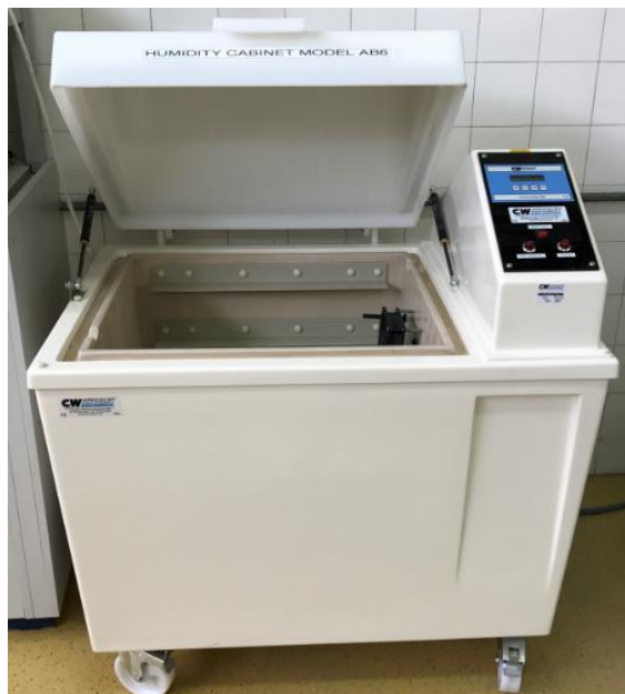
Slika 40. Vlažna komora „HUMIDITY CABINET MODEL AB6“, Laboratorij za zaštitu materijala, FSB
