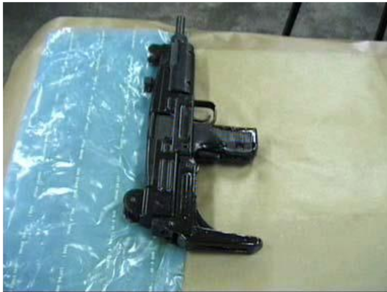
Slika 17. Primjena hlapljivih inhibitora korozije u foliji za zaštitu oružja [18]
