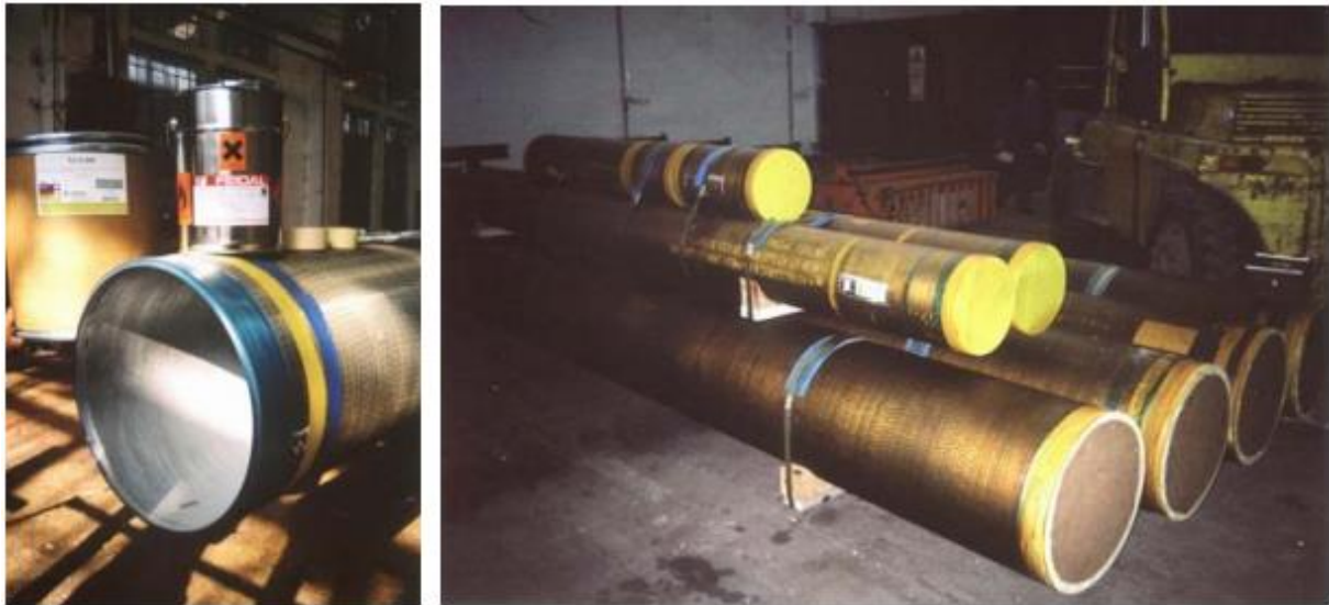
Slika 16. Zaštita unutrašnjosti cijevi inhibitorom korozije u prahu [18]
