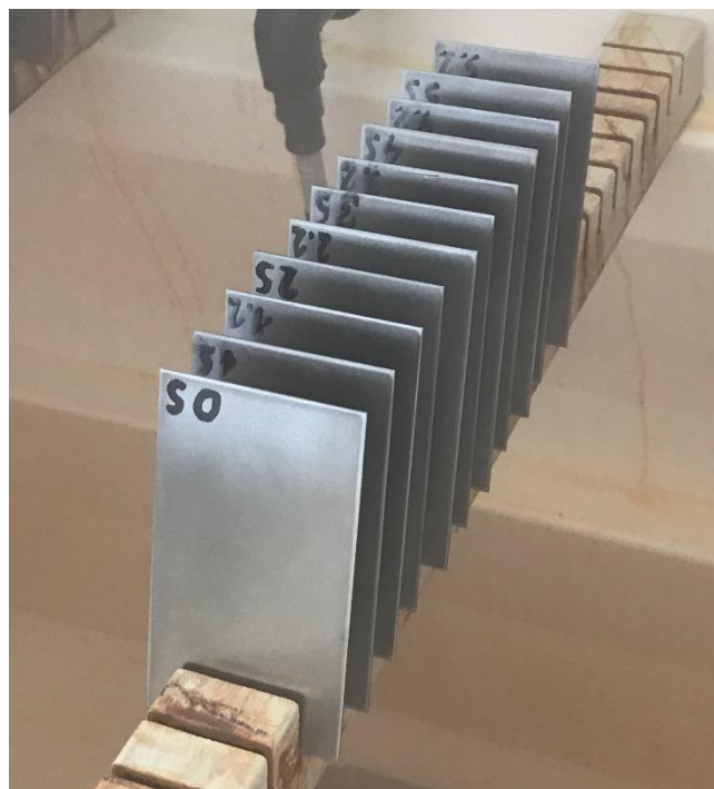
Slika 39. Način slaganja uzoraka u slanoj komori, početak ispitivanja
