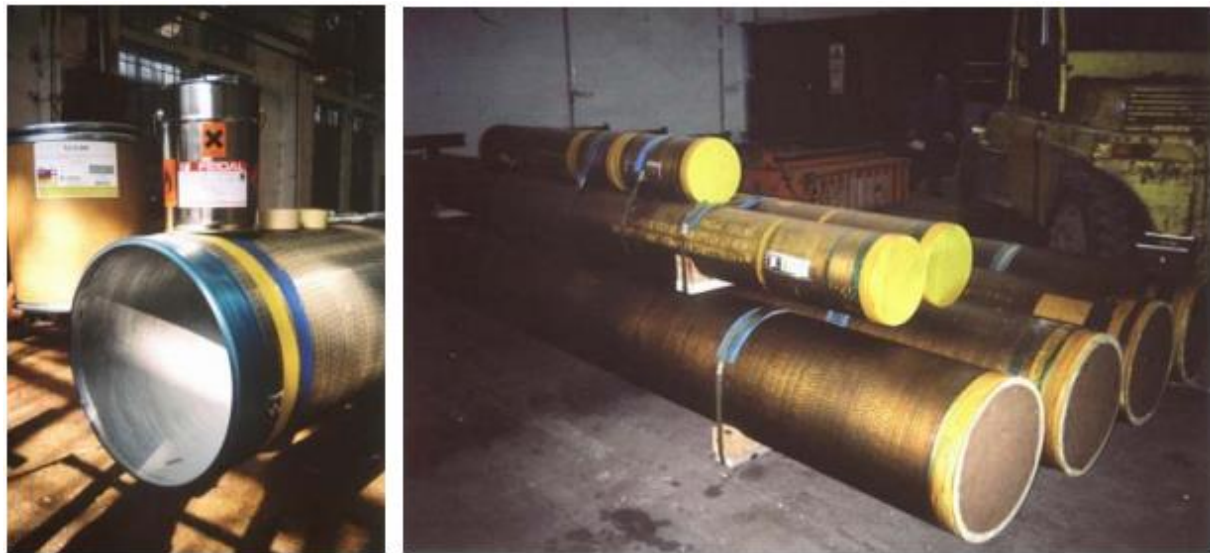
Slika 16. Zaštita unutrašnjosti cijevi inhibitorom korozije u prahu [18]
