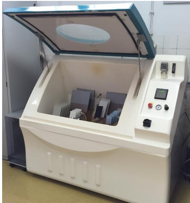
Slika 37. Slana komora Ascott, model S450, Laboratorij za zaštitu materijala, FSB
