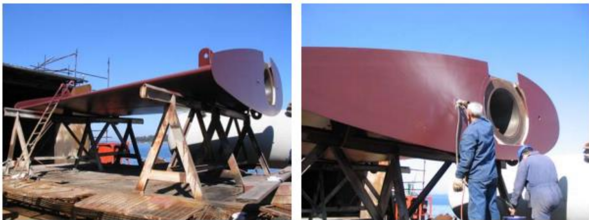
Slika 19. Primjena inhibitora korozije u prahu za zaštitu unutrašnjosti lista kormila [18]
