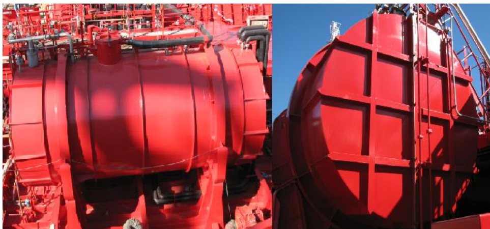
Slika 8. Spremnik od nehrđajućeg čelika dodatno zaštićen organskim premazima [13]
