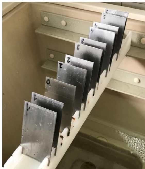
Slika 41. Način slaganja uzoraka u vlažnoj komori
