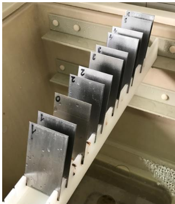
Slika 41. Način slaganja uzoraka u vlažnoj komori
