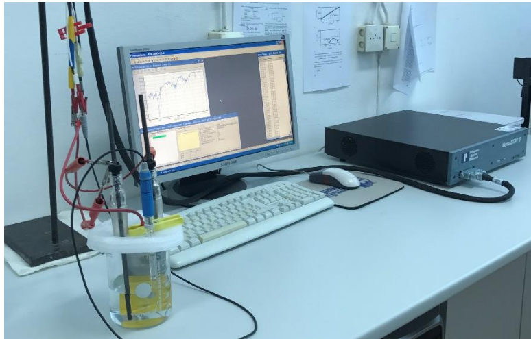
Slika 52. Oprema za ispitivanje EIS, Laboratorij za zaštitu materijala, FSB
