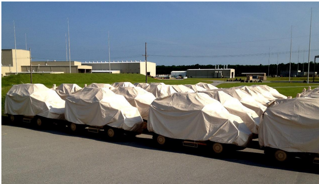
Slika 18. Primjena inhibitora korozije u foliji za zaštitu vojnih vozila [20]
