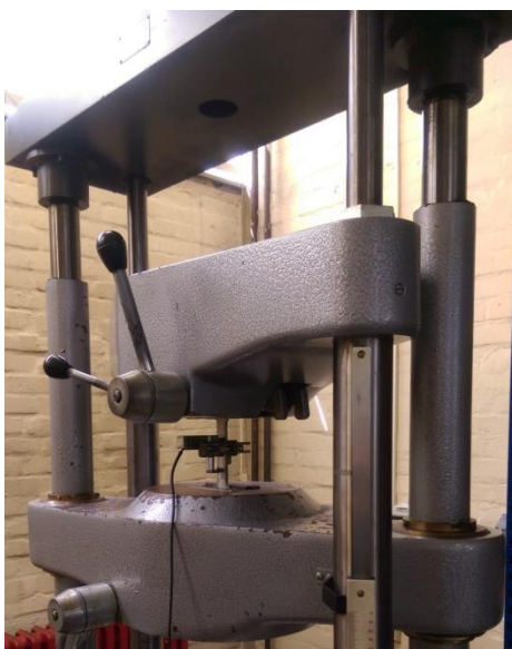
Slika 28. Kidalica i uzorak postavljen za testiranje
