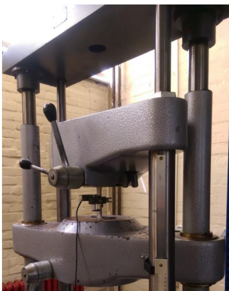
Slika 28. Kidalica i uzorak postavljen za testiranje
