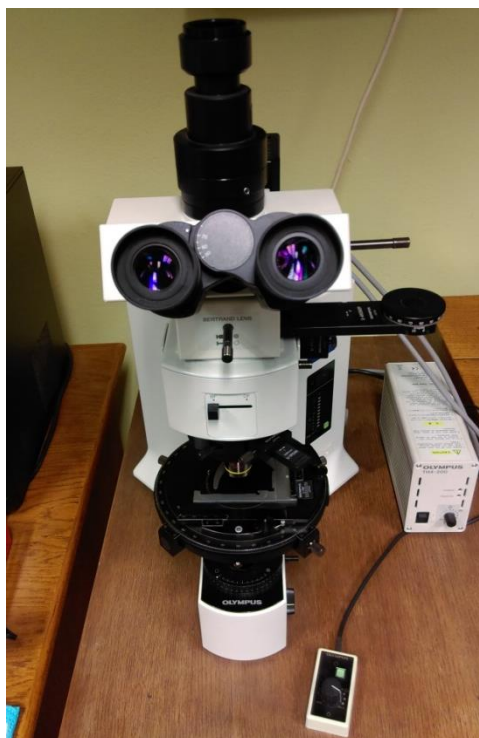
Slika 4.5. Svjetlosni mikroskop OLYMPUS BX51
