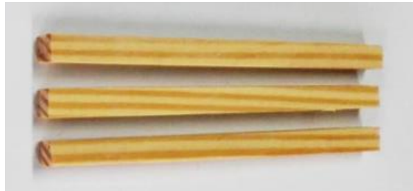
Slika 4.27. Uzorci smreke za ispitivanje otpornosti na abrazijsko trošenje
