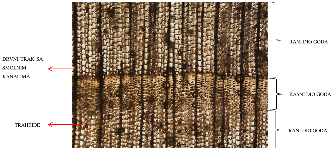
Slika 4.18. Mikrstruktura poprečnog presjeka ariša
