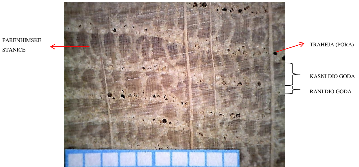
Slika 4.6. Makrostruktura poprečnog presjeka hrasta
