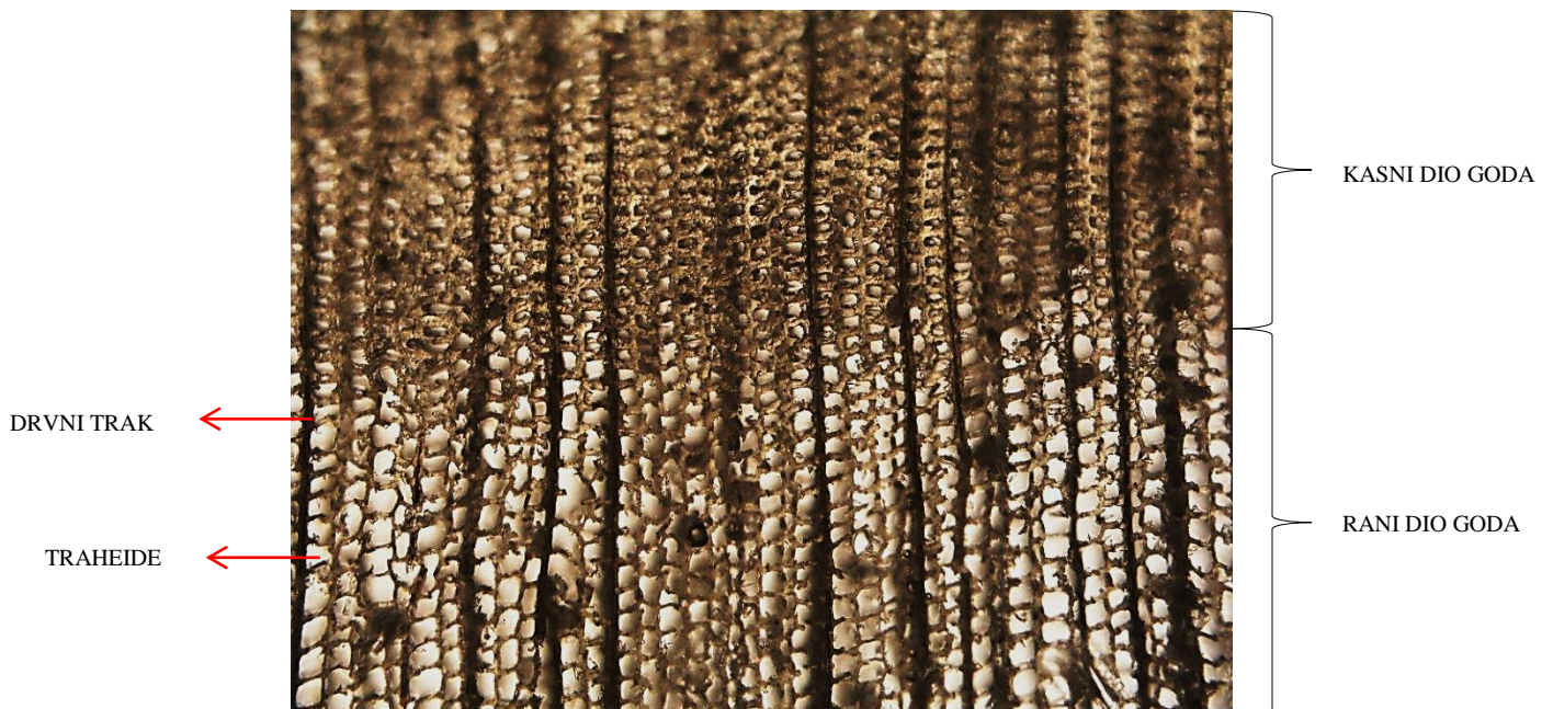
Slika 4.14. Mikrostruktura poprečnog presjeka jele
