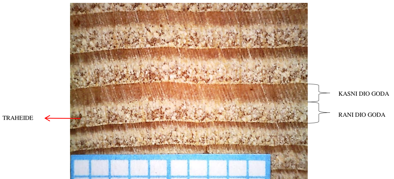
Slika 4.15. Površina poprečnog presjeka smreke
