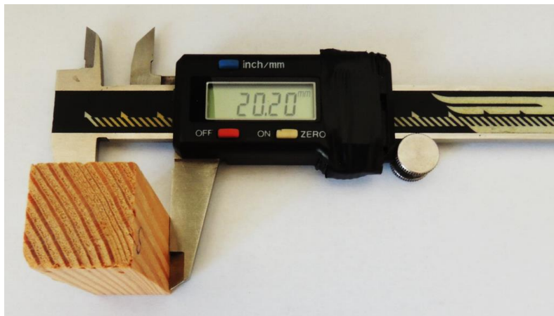
Slika 4.19. Mjerenja dimenzija uzorka za određivanje gustoće
