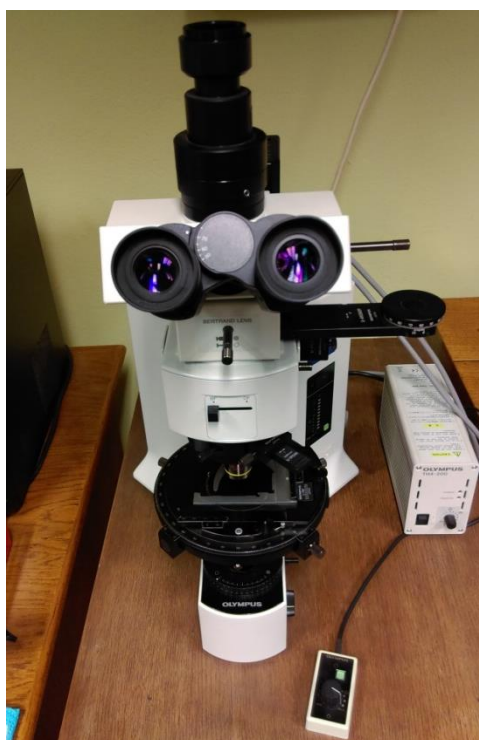
Slika 4.5. Svjetlosni mikroskop OLYMPUS BX51
