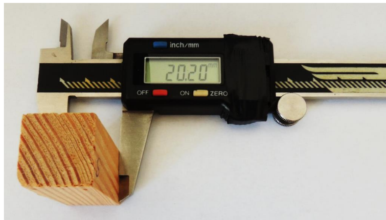
Slika 4.19. Mjerenja dimenzija uzorka za određivanje gustoće
