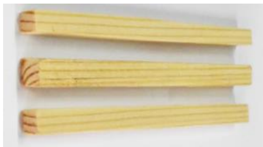
Slika 4.28. Uzorci ariša za ispitivanje otpornosti na abrazijsko trošenje
