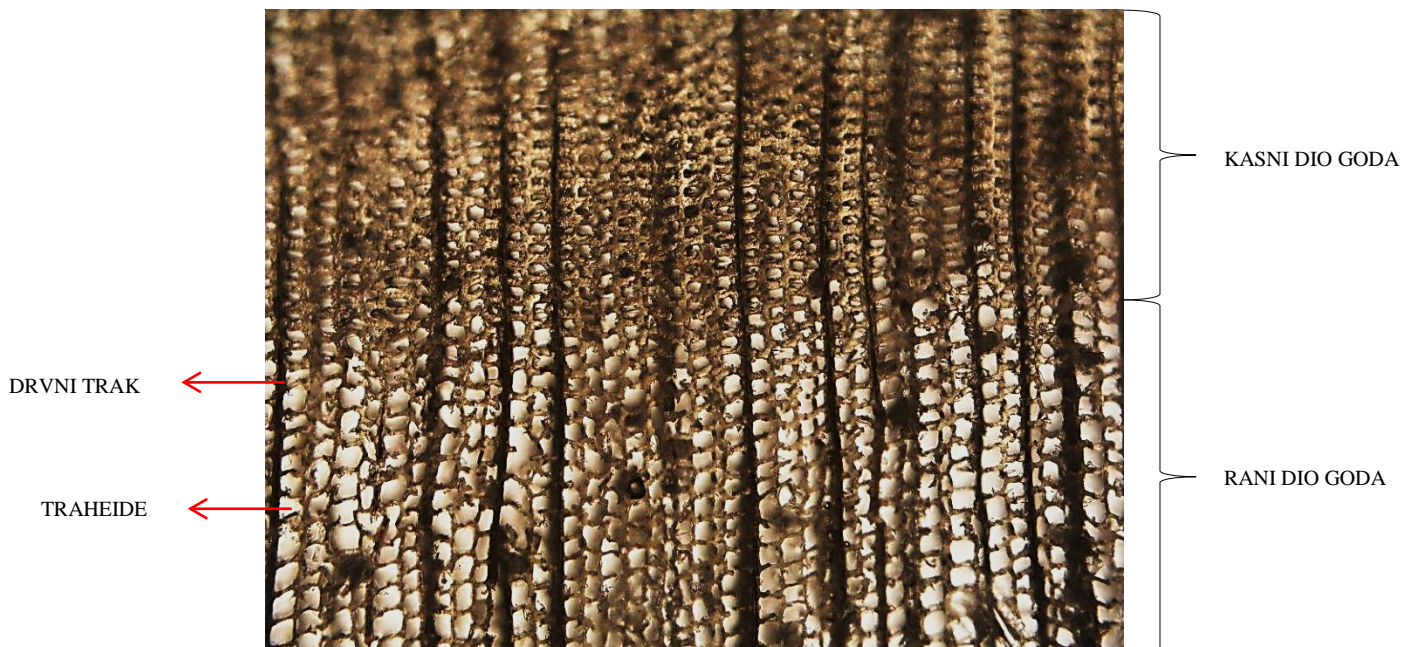
Slika 4.14. Mikrostruktura poprečnog presjeka jele
