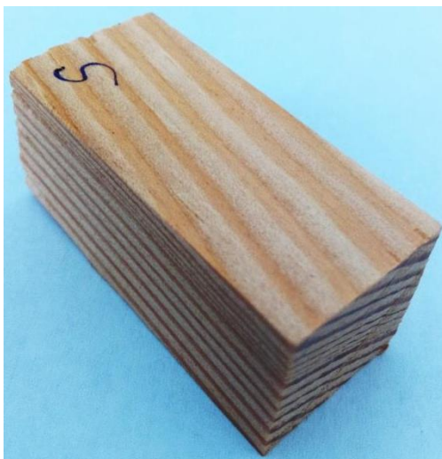
Slika 4.2. Uzorak za određivanje makrostrukture i gustoće
