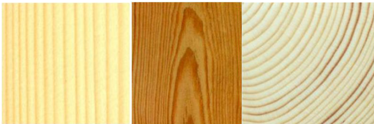
Slika 3.16. Tekstura radijalnog (lijevo), tangencijalnog (sredina) i poprečnog (desno) presjeka drva [40]
