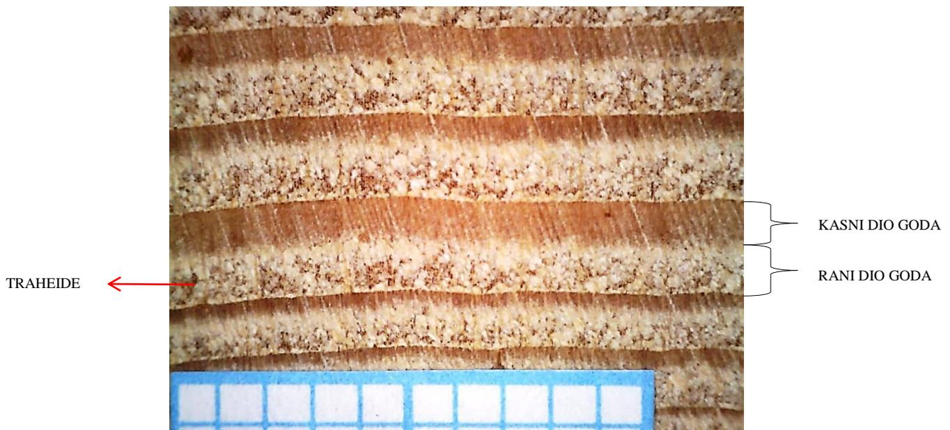
**Slika 4.15. Površina poprečnog presjeka smreke**
