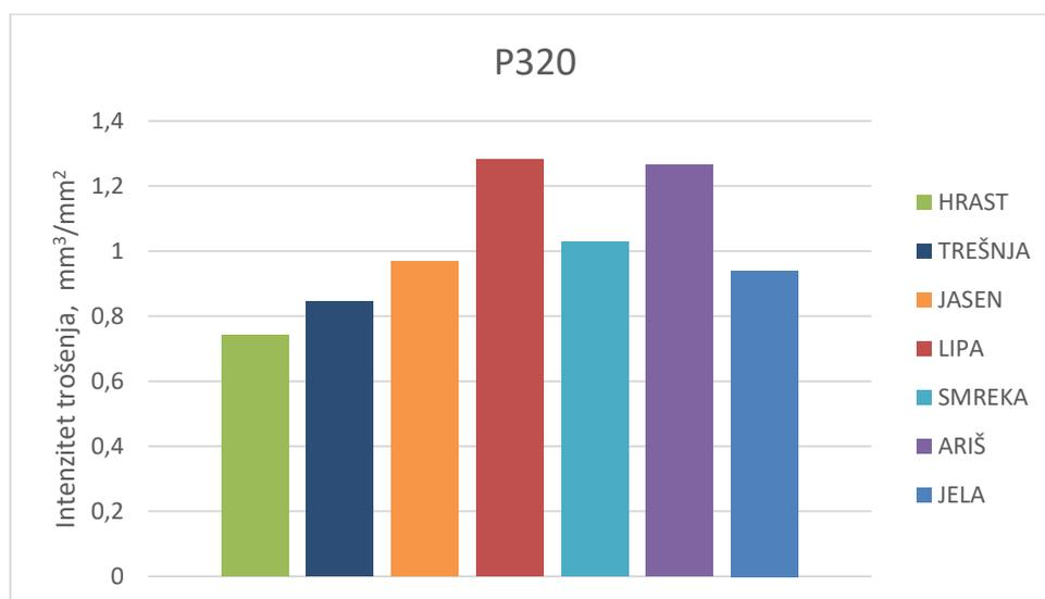
**Slika 4.34. Intenzitet trošenja drva na brusnom papiru P320**
