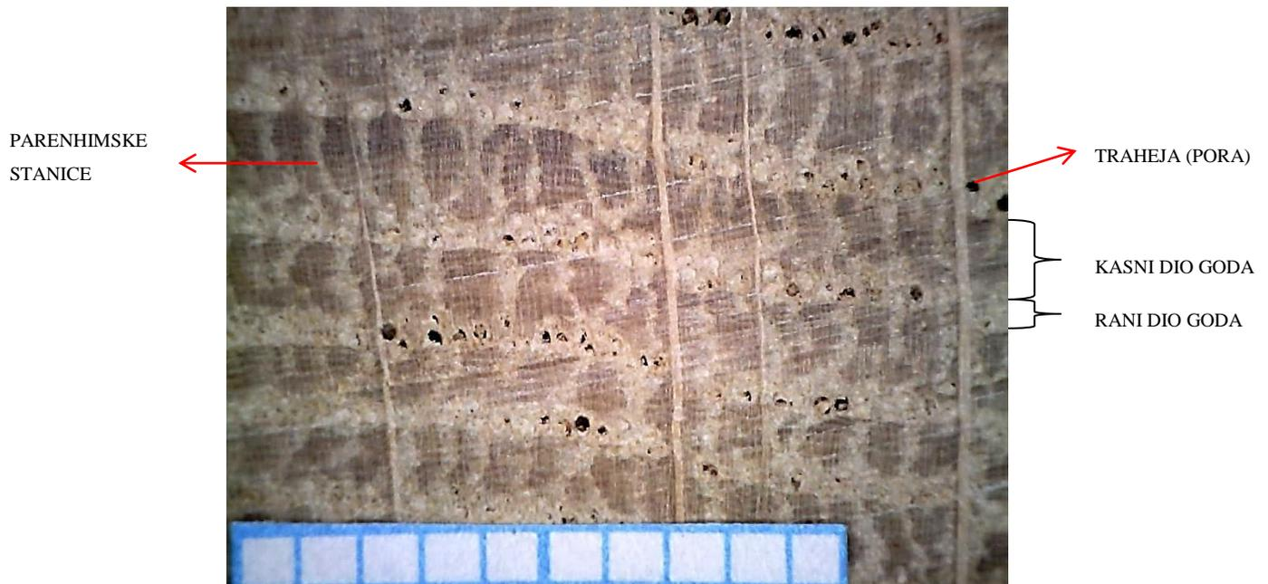
**Slika 4.6. Makrostruktura poprečnog presjeka hrasta**
