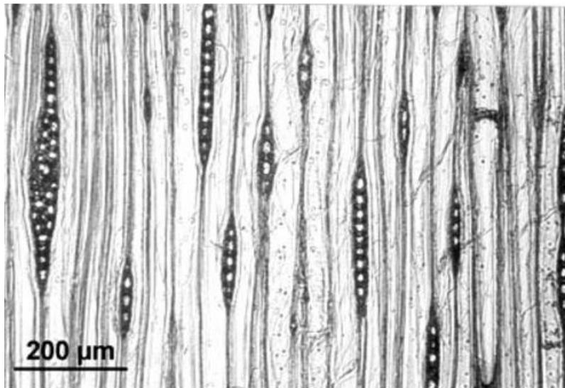
**Slika 2.13. Drvni traci s jednim i više redova stanica (tangencijalni presjek) [12]**
