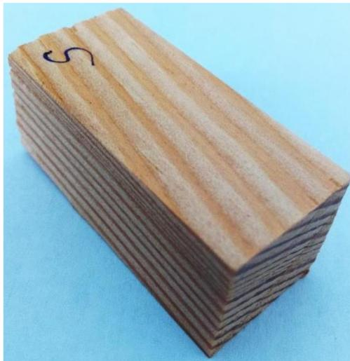
**Slika 4.2. Uzorak za određivanje makrostrukture i gustoće**
