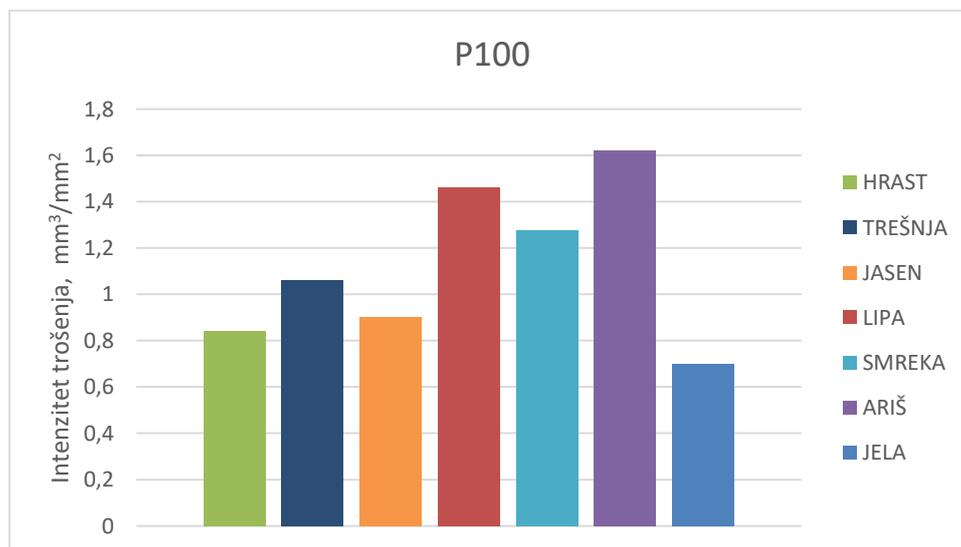
Slika 4.31. Intenzitet trošenja drva na brusnom papiru P100
