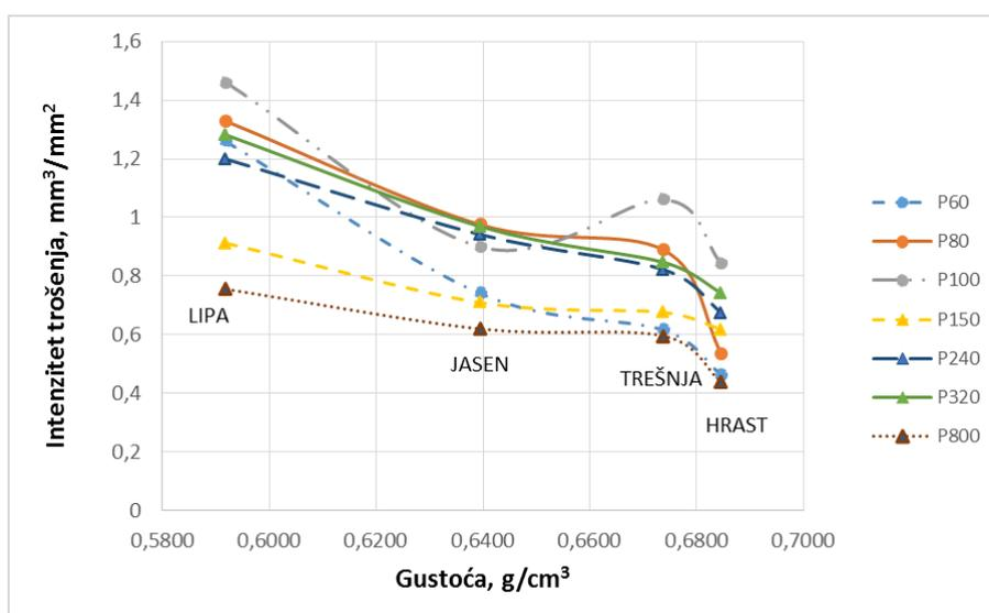
**Slika 5.1. Utjecaj gustoće drva listača na intenzitet abrazijskog trošenja**
