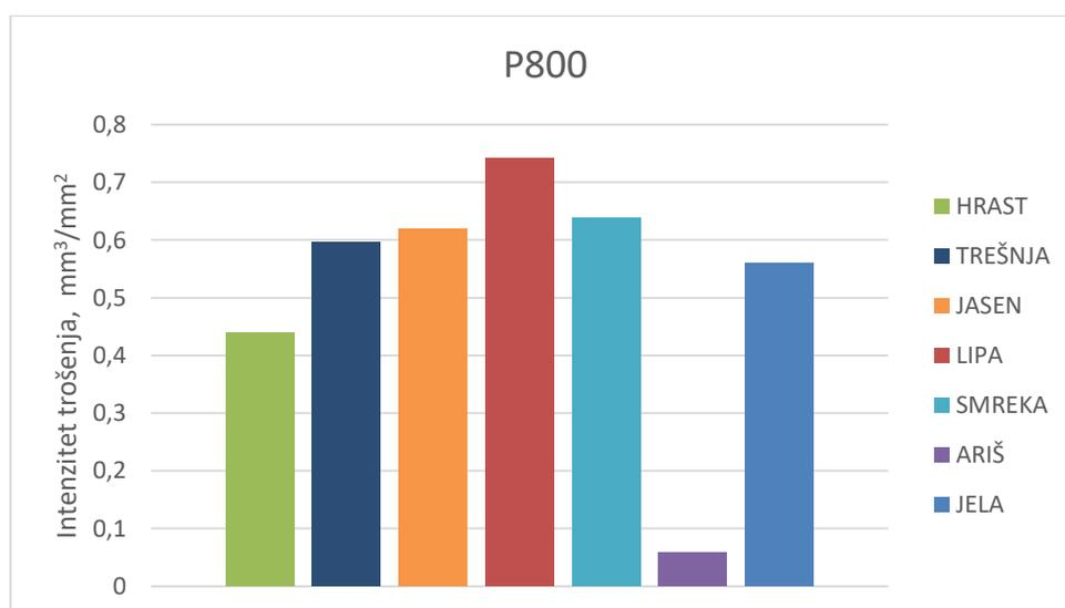
**Slika 4.35. Intenzitet trošenja drva na brusnom papiru P800**
