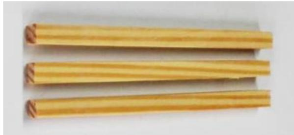
**Slika 4.27. Uzorci smreke za ispitivanje otpornosti na abrazijsko trošenje**
