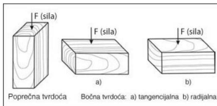
**Slika 3.7. Razlika između mjerenja poprečne i bočne tvrdoće [31]**
