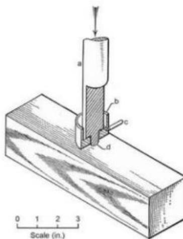
**Slika 3.8. Ispitivanje tvrdoće metodom po Janki [4]**
