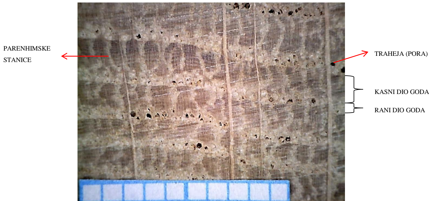
Slika 4.6. Makrostruktura poprečnog presjeka hrasta
