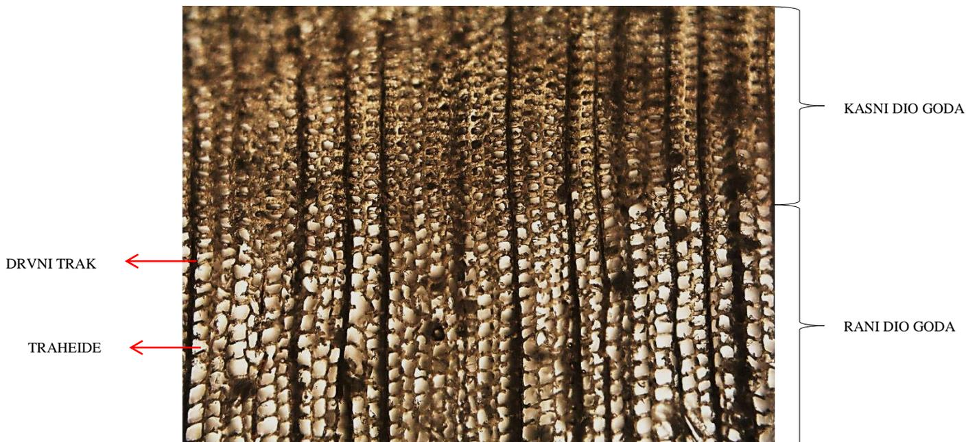
**Slika 4.14. Mikrostruktura poprečnog presjeka jele**
