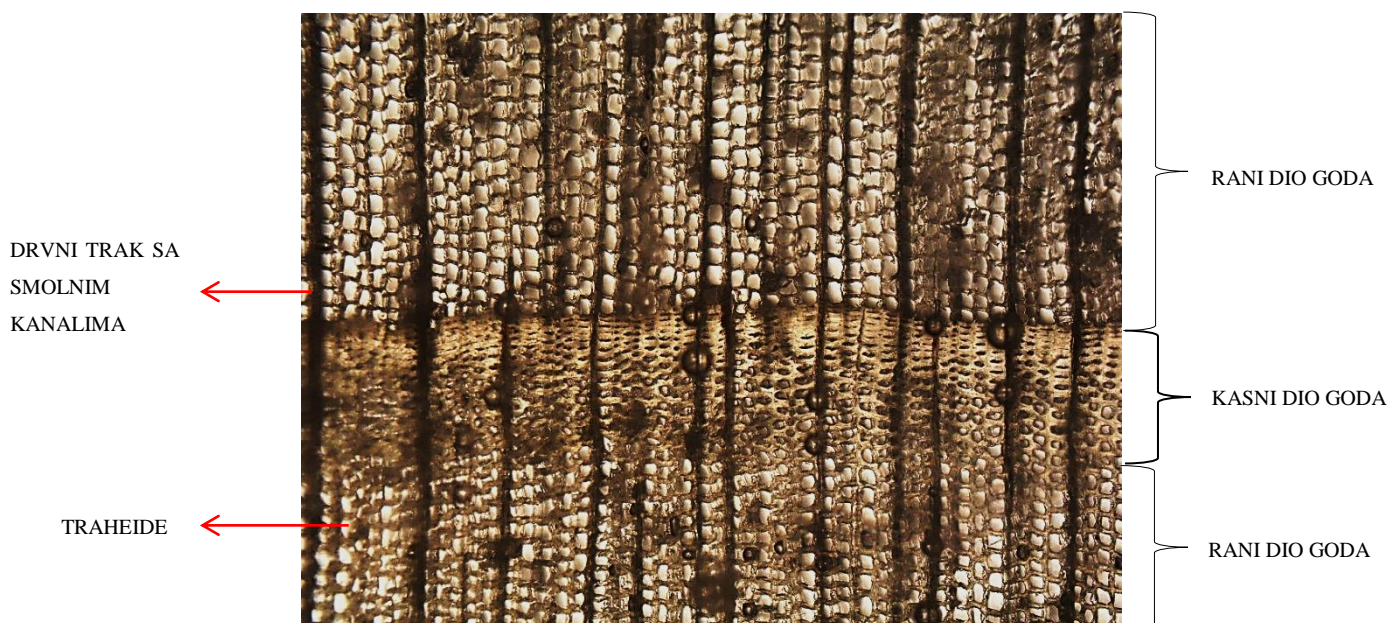
Slika 4.18. Mikrstruktura poprečnog presjeka ariša
