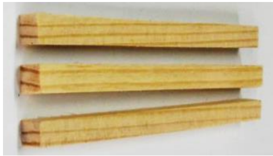
Slika 4.26. Uzorci jela za ispitivanje otpornosti na abrazijsko trošenje
