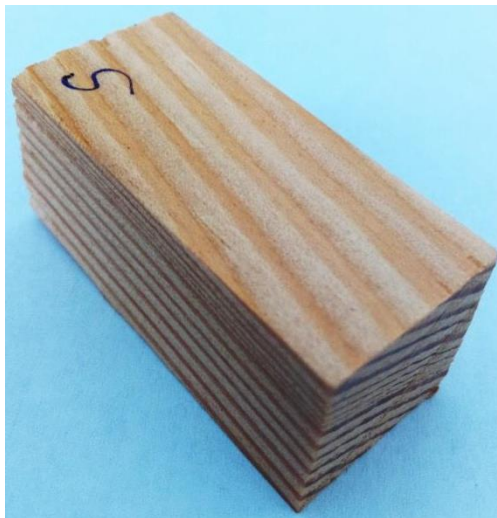
Slika 4.2. Uzorak za određivanje makrostrukture i gustoće
