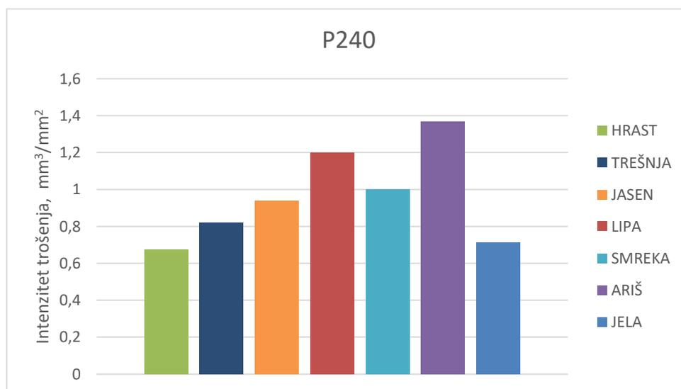
Slika 4.33. Intenzitet trošenja drva na brusnom papiru P240
