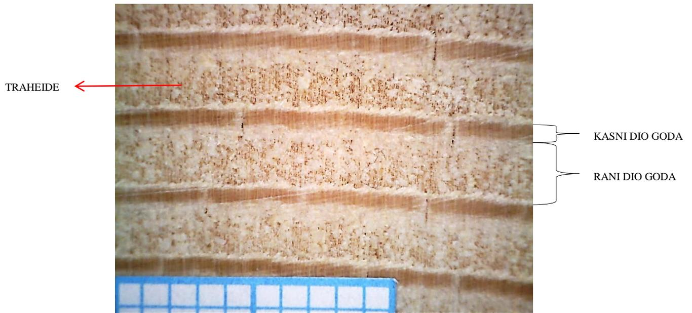
**Slika 4.13. Makrostruktura poprečnog presjeka jele**
