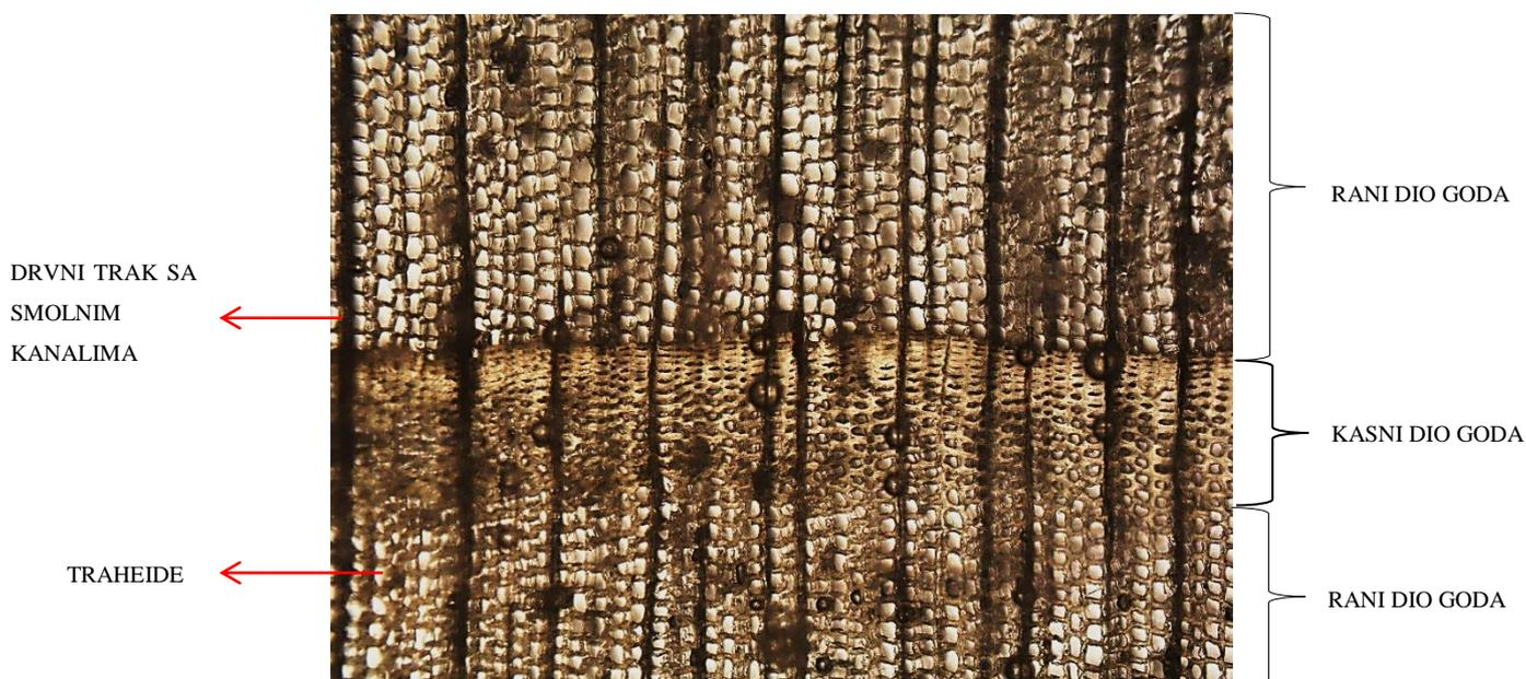
**Slika 4.18. Mikrstruktura poprečnog presjeka ariša**
