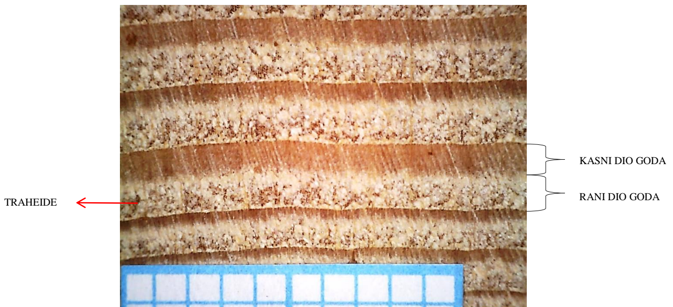
Slika 4.15. Površina poprečnog presjeka smreke
