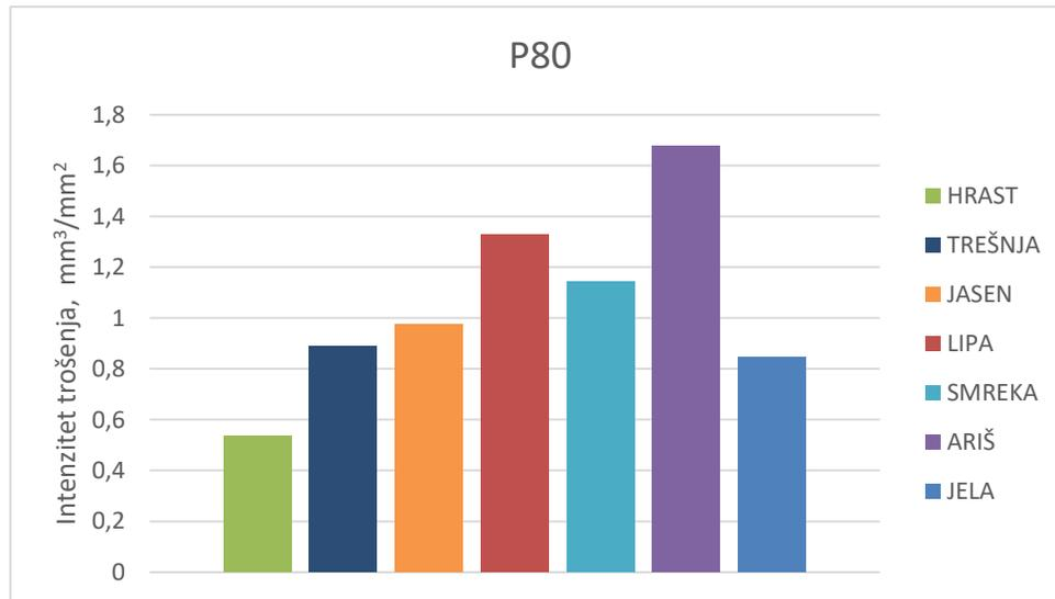
Slika 4.30. Intenzitet trošenja drva na brusnom papiru P80
