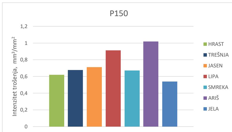
Slika 4.32. Intenzitet trošenja drva na brusnom papiru P150
