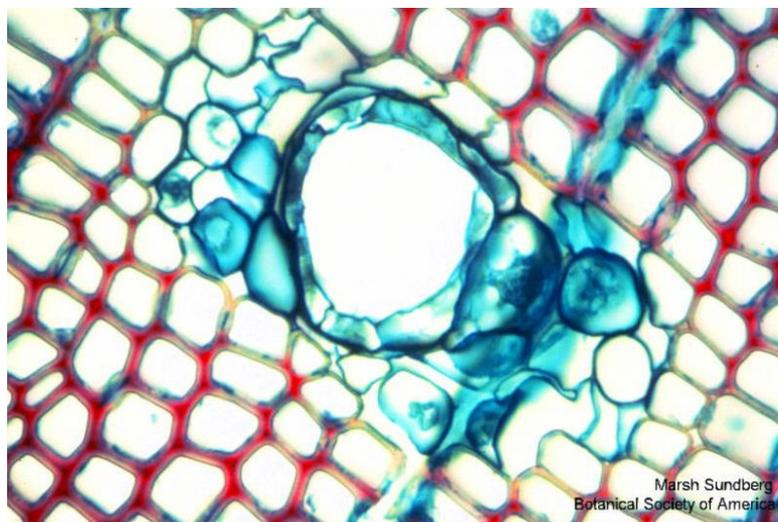
**Slika 2.14. Aksijalna smolenica bora (poprečni presjek) [13]**
