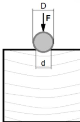
**Slika 3.9. Shematski prikaz mjerenja tvrdoće po Brinellu [4]**
