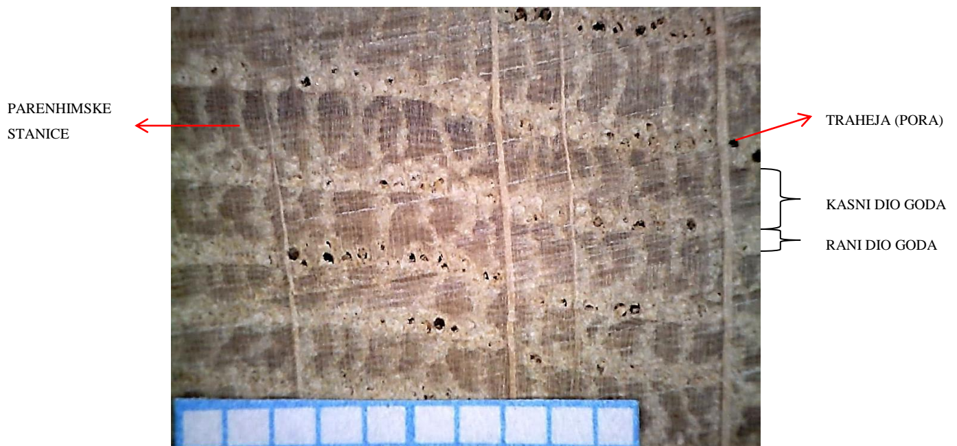
Slika 4.6. Makrostruktura poprečnog presjeka hrasta
