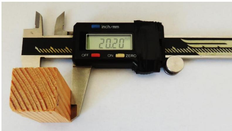
**Slika 4.19. Mjerenja dimenzija uzorka za određivanje gustoće**
