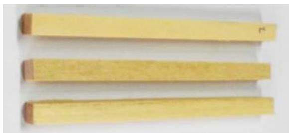
**Slika 4.25. Uzorci lipe za ispitivanje otpornosti na abrazijsko trošenje**
