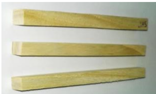
Slika 4.23. Uzorci jasena za ispitivanje otpornosti na abrazijsko trošenje
