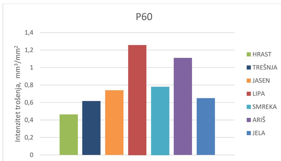
**Slika 4.29. Intenzitet trošenja drva na brusnom papiru P60**
