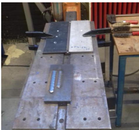
Slika 36. Uzorak 1 na radnom stolu prije zavarivanja
