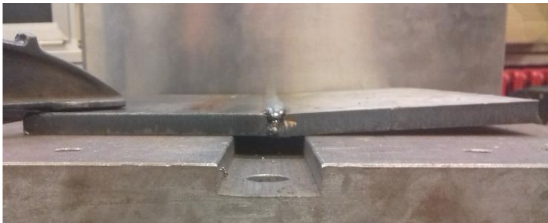
Slika 46. Deformacije drugog uzorka (prednji pogled)
