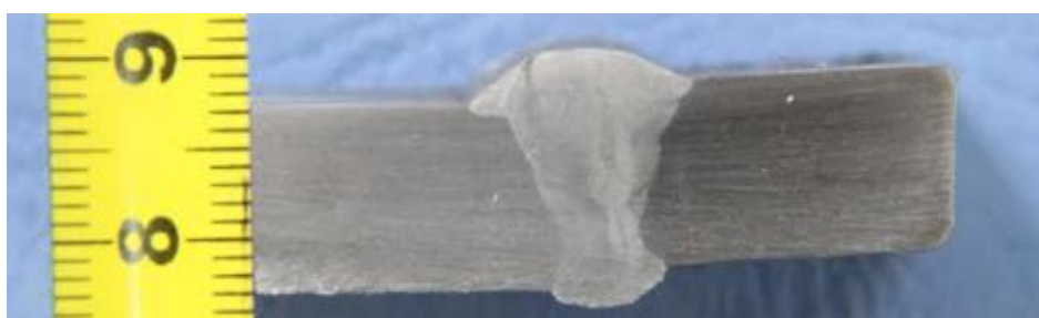
Slika 51. Makroizbrusak uzorka 3 ( v_z = 30 cm/min)
