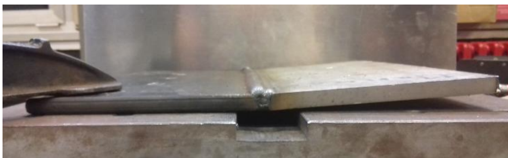
Slika 44. Deformacije prvog uzorka (prednji pogled)
