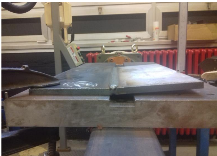
Slika 41. Mjerenje deformacija na zavarenim uzorcima
