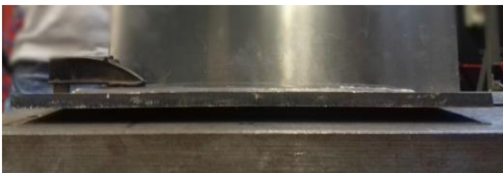
Slika 43. Deformacije prvog uzorka (bočni pogled)
