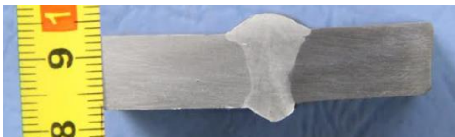
Slika 50. Makroizbrusak uzorka 2 ( v_z = 45 cm/min)
