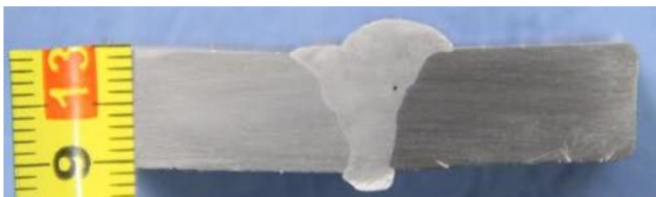
Slika 49. Makroizbrusak uzorka 1 ( v_z = 14 cm/min)
