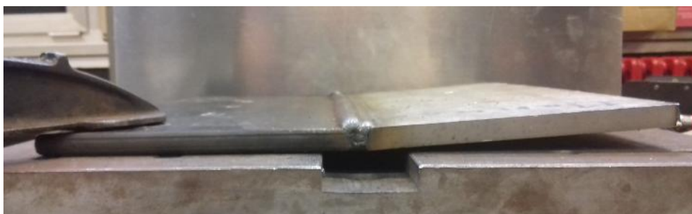
Slika 44. Deformacije prvog uzorka (prednji pogled)
