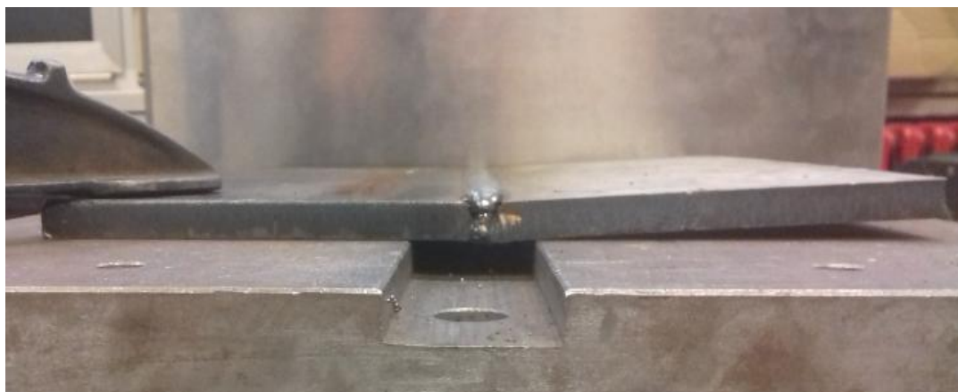
Slika 46. Deformacije drugog uzorka (prednji pogled)
