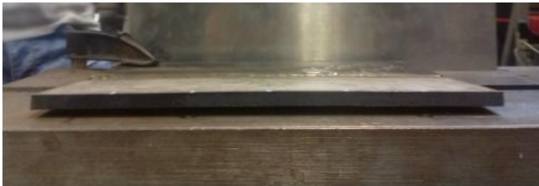
Slika 45. Deformacije drugog uzorka (bočni pogled)
