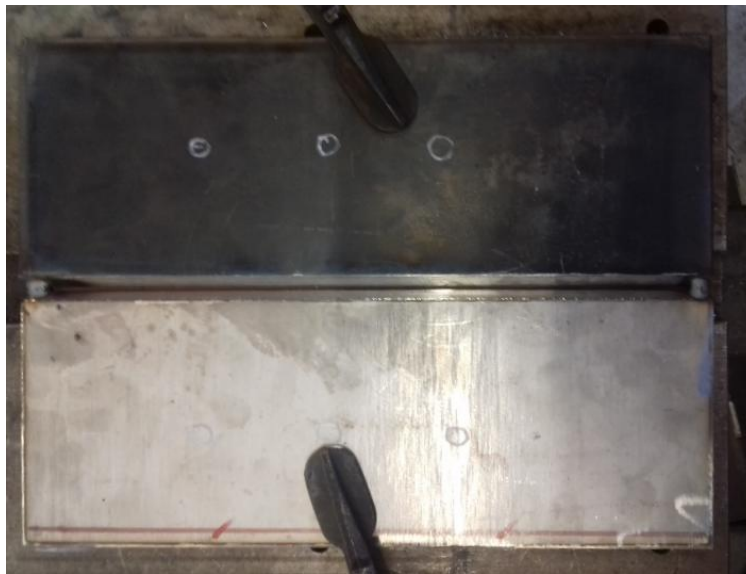
Slika 38. Uzorak 2 stegnut na radnom stolu prije zavarivanja
