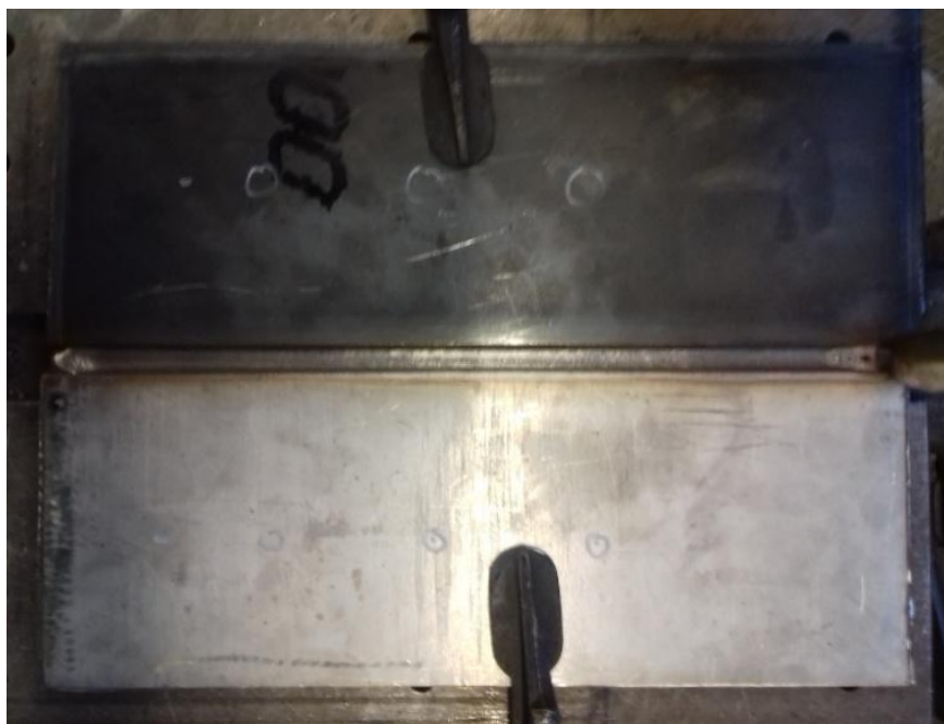
Slika 40. Uzorak 3 stegnut na radnom stolu nakon prvog prolaza
