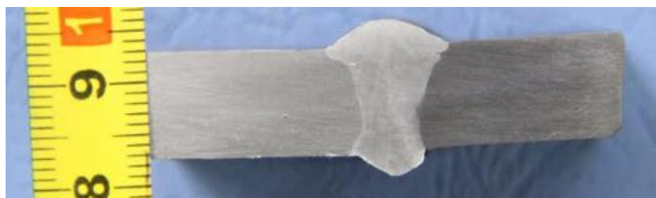
Slika 50. Makroizbrusak uzorka 2 ( v_z = 45 cm/min)
