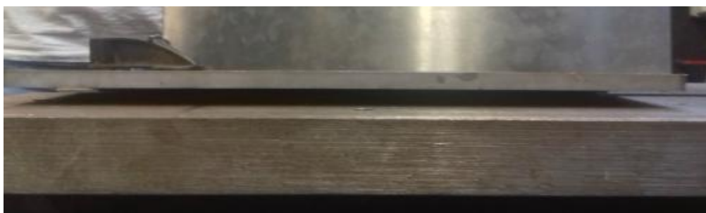
Slika 47. Deformacije trećeg uzorka (bočni pogled)
