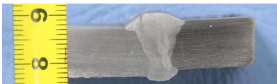
Slika 51. Makroizbrusak uzorka 3 ( v_z = 30 cm/min)
