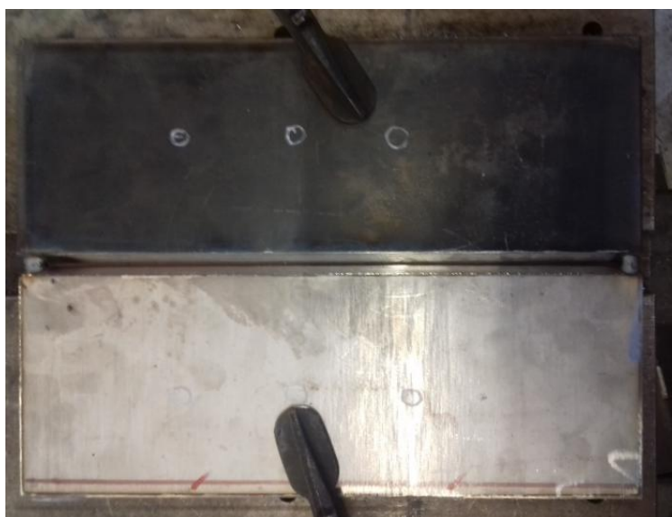
Slika 38. Uzorak 2 stegnut na radnom stolu prije zavarivanja
