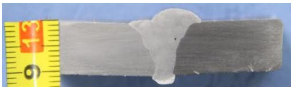
Slika 49. Makroizbrusak uzorka 1 ( v_z = 14 cm/min)
