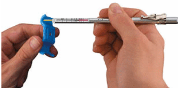
Slika 3.1. Magnetski pull-off uređaj u obliku olovke 3
