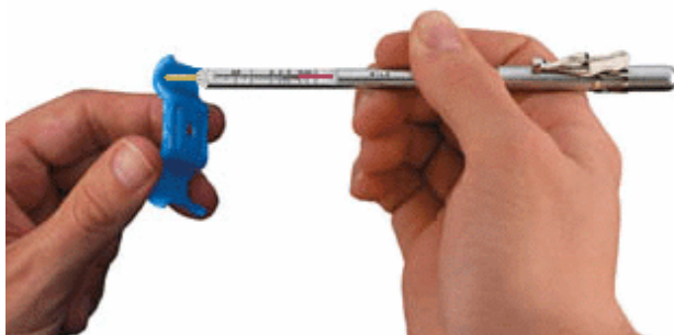
Slika 3.1. Magnetski pull-off uređaj u obliku olovke 3
