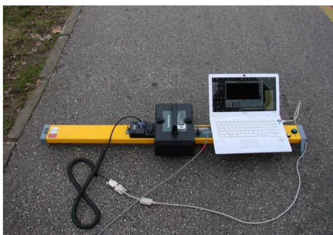
Slika 18. SCM uređaj za mjerenje lutajućih struja [19]
