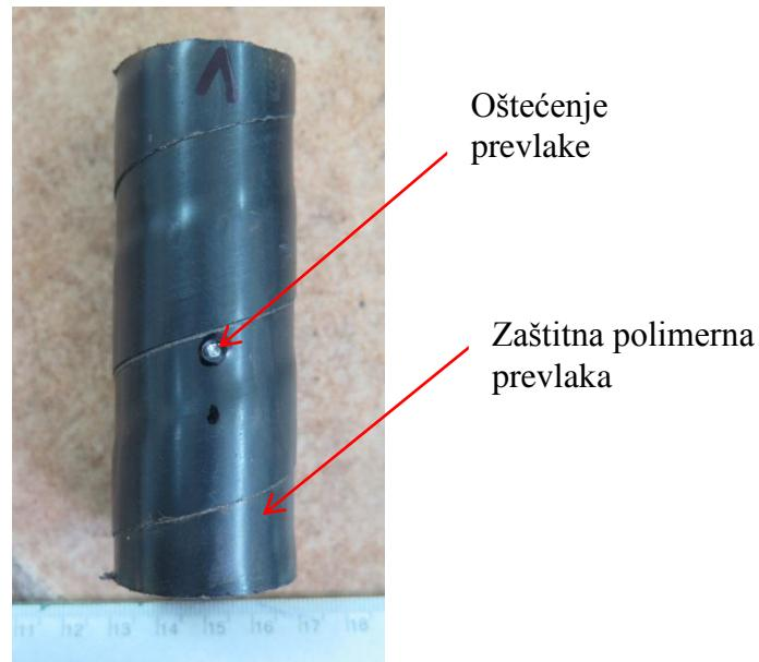
Slika 26. Prikaz uzorka s izvedenim oštećenjem prevlake
