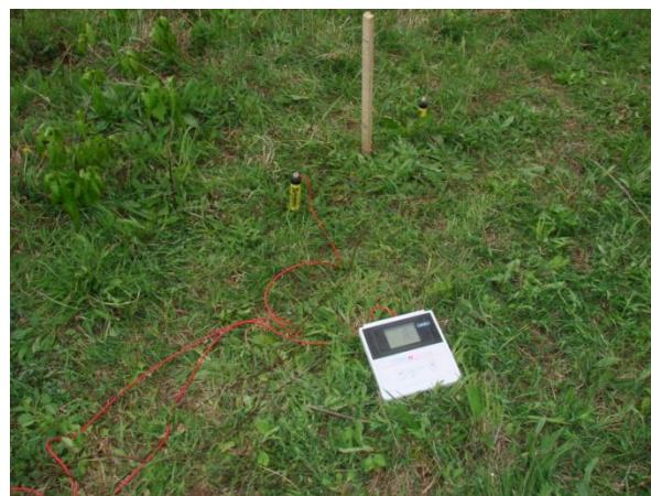
**Slika 16. Neizravno ispitivanje – mjerjenje gradijenta potencijala na površini [19]**
