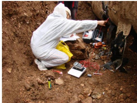
**Slika 15. Izravno mjerjenje potencijala cjevovod – tlo u iskopu [19]**
