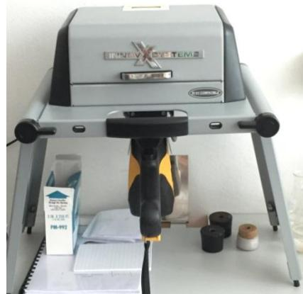
Slika 22. Olympus XRF analizator
