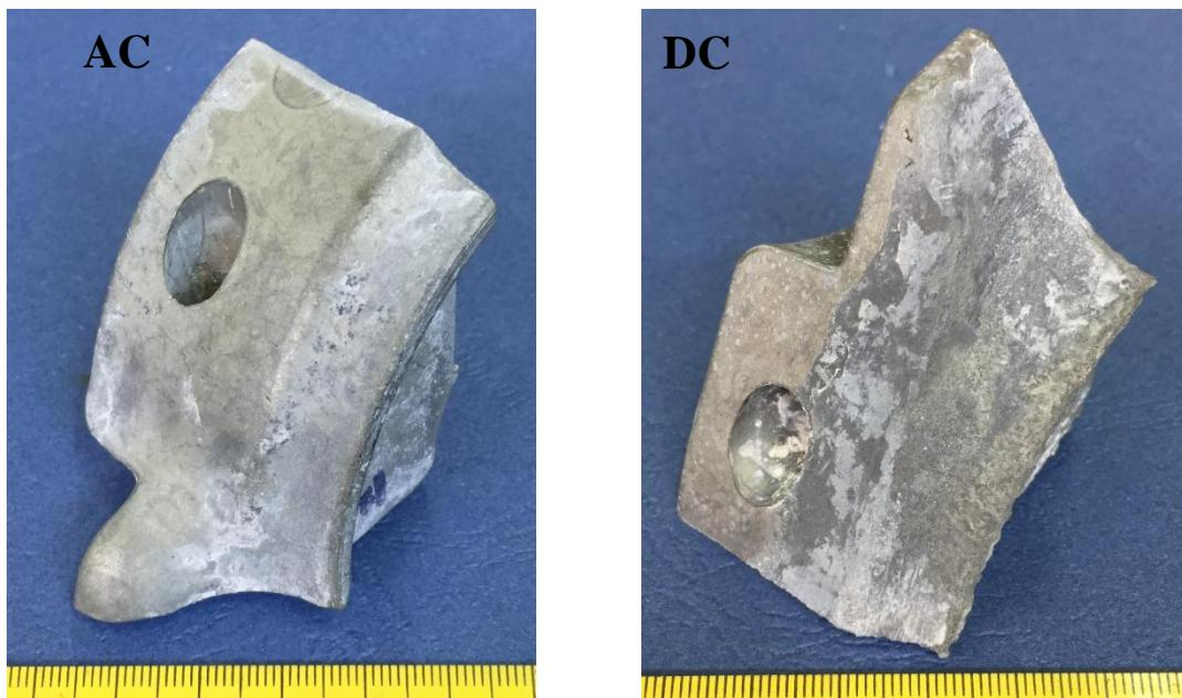
Slika 39. Prikaz oštećenja anoda uzrokovanih lutajućim strujama; lijevo – anoda Z1, desno anoda Z3
