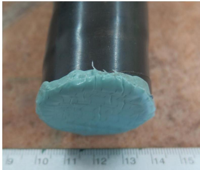
**Slika 28. Rub uzorka zaštićen STOPAQ® trakom**
