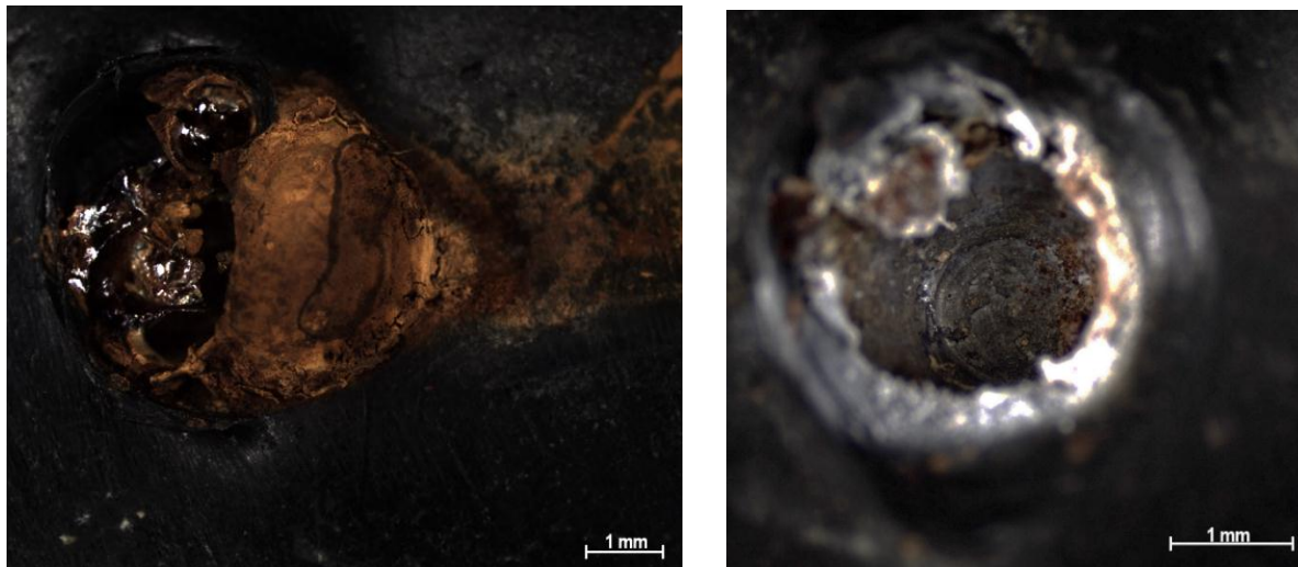
Slika 34. Stereomikroskopske snimke oba područja s oštećenjem zaštitne prevlake uzorka izloženog djelovanju DC lutajuće struje (uzorak 4). Na mjestu izlaska lutajuće struje vidljiv je intenzivan nastanak korozijskih produkata (lijevo) kojih nema u zoni nasuprot MMO anode (desno)
