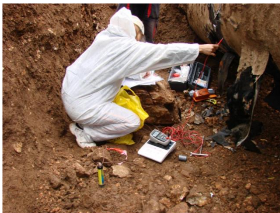
Slika 15. Izravno mjerenje potencijala cjevovod – tlo u iskopu [19]
