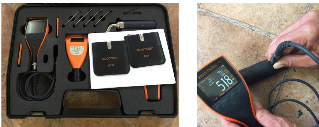
Slika 25. Mjerni set Elcometer 456 s uređajem za ispitivanje debljine prevlake (lijevo), postupak mjerenja debljine prevlake (desno)
