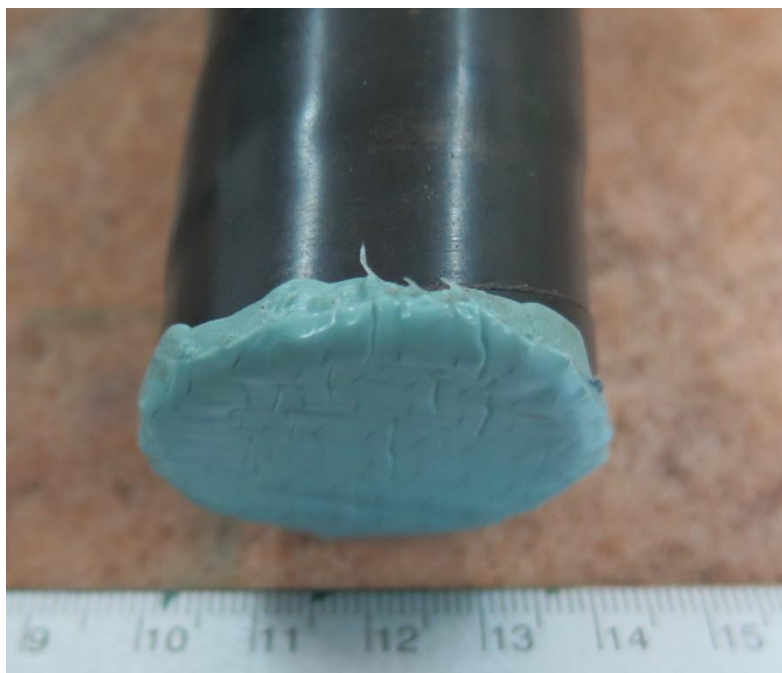
Slika 28. Rub uzorka zaštićen STOPAQ® trakom
