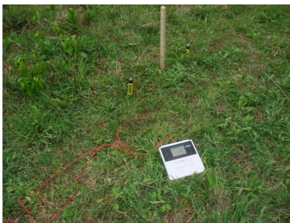
Slika 16. Neizravno ispitivanje – mjerenje gradijenta potencijala na površini [19]
