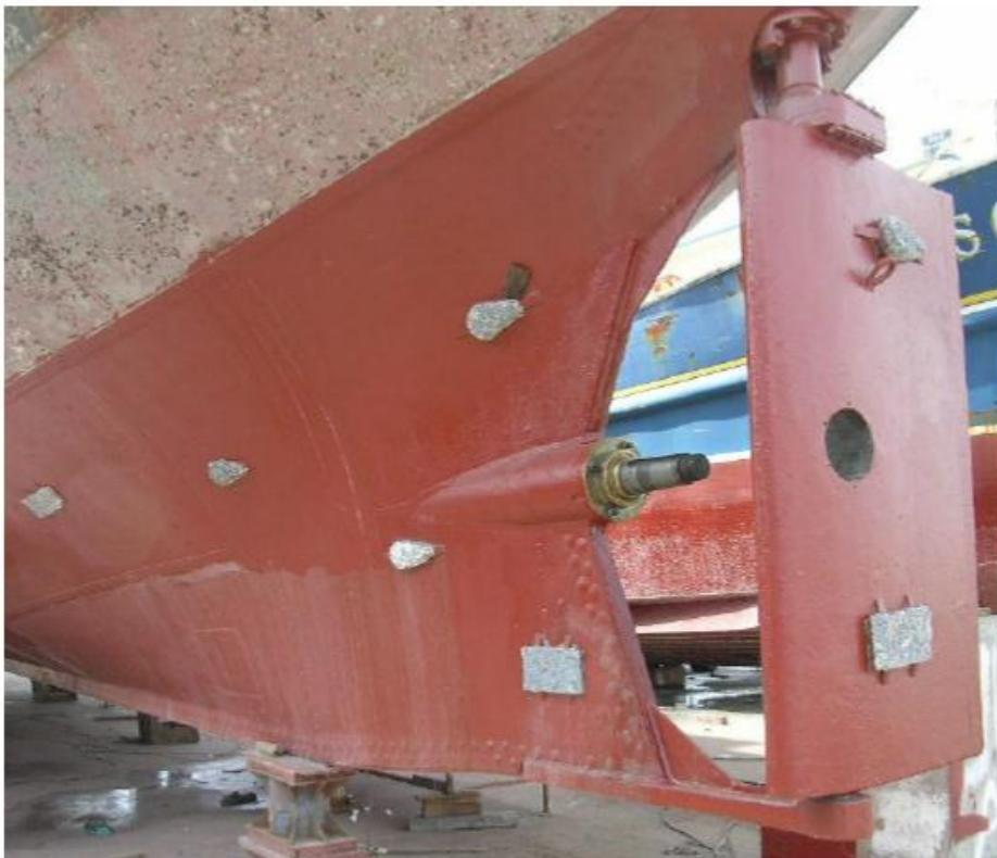
**Slika 4. Protektorska zaštita podvodnog dijela čeličnog trupa broda žrtvajućim anodama od cinka [8]**
