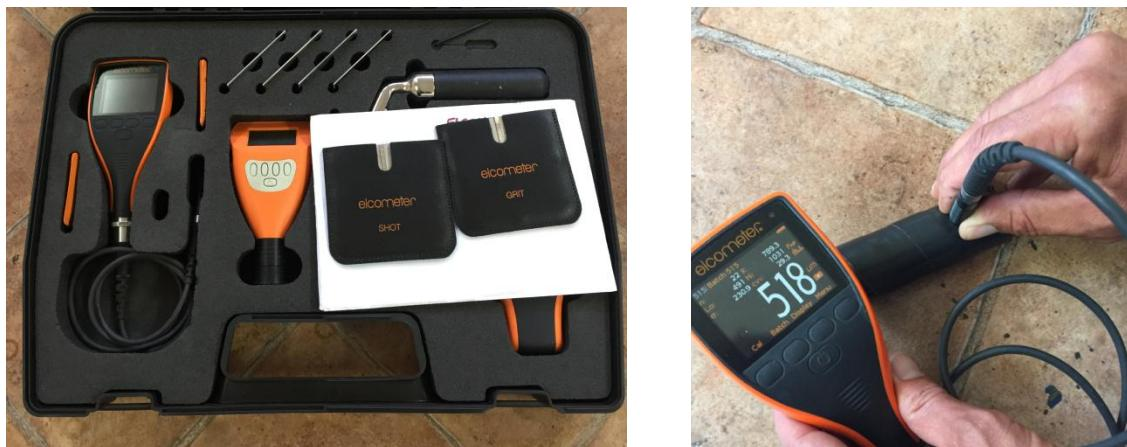
**Slika 25.** Mjerni set Elcometer 456 s uređajem za ispitivanje debljine prevlake (lijevo), postupak mjerena debljine prevlake (desno)
