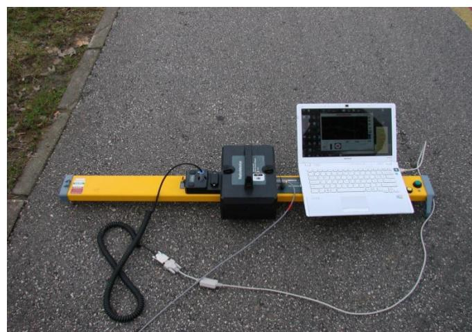
**Slika 18. SCM uređaj za mjerjenje lutajućih struja [19]**
