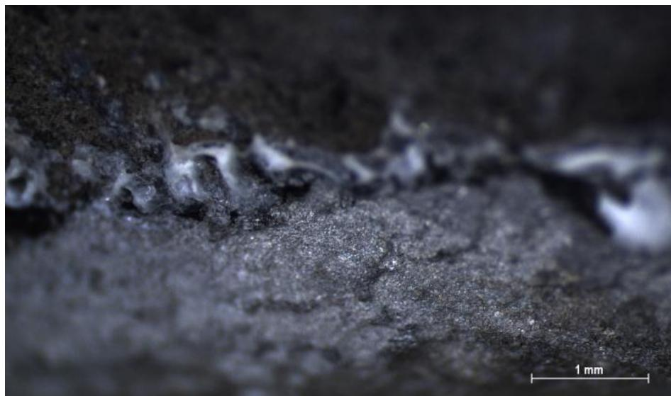
**Slika 46.** Stereomikroskopske snimke površine anoda od Al legure nakon ispitivanja: gornja slika – lokalna oštećenja anode A1 izložene AC struji, donja slika – granica oštećenja anode A3 izložene djelovanju DC struje
