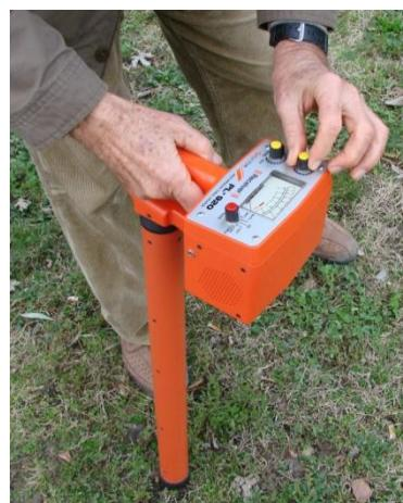
Slika 17. Lociranje cjevovoda tragačem (lokatorom) [19]
