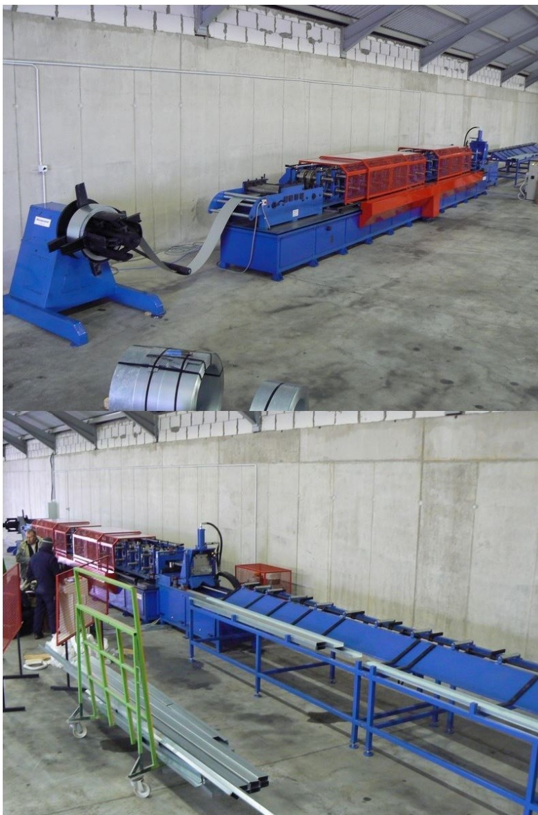
Slika. 21. Automatska linija za proizvodnju perforiranih kabelskih kanala [13.]
