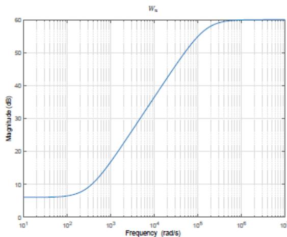
Slika 16: Frekvencijska karakteristika visoko propusnog filtera  $W_u$
