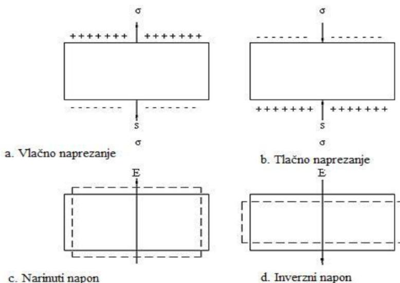
Slika 2: Piezoelektrični efekt [2]
