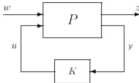
Slika 13: Blok dijagram općenitog sustava [7]
