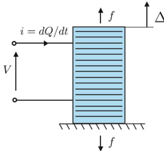
Slika 4: Piezoelektrični pretvornik [1]
