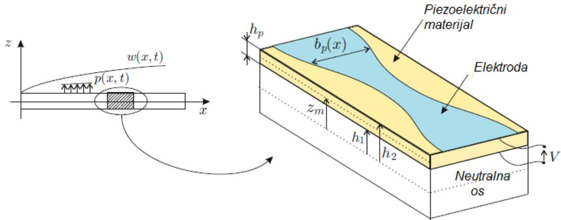
Slika 5: Piezoelektrična greda s piezoelektričnim slojem i elektrodom [1]
