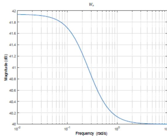
Slika 14: Frekvencijska karakteristika nisko propusnog filtera  $W_z$
