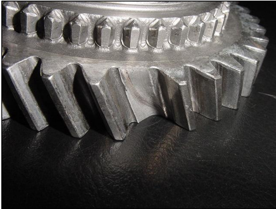
Slika 8. Lom zuba zupčanika s kosim zubima uslijed zamora materijala [7]
