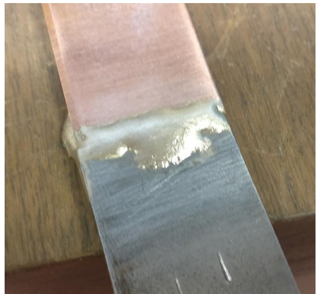
Slika 35: Vizualno dobar spoj (uzorak 11)
