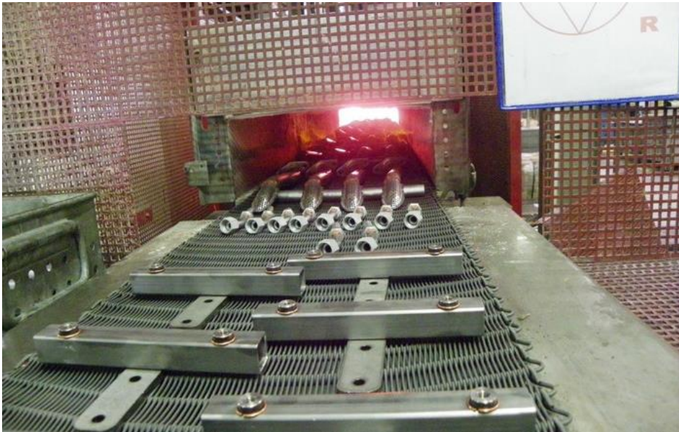
Slika 5: Ulazak dijelova u prolaznu peć [9]
