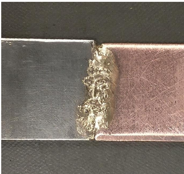
Slika 34: Vizualno loš spoj (uzorak 22)
