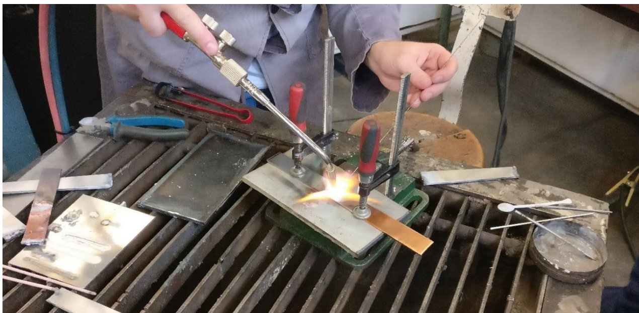
Slika 30: Postupak lemljenja uzoraka
