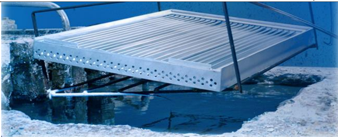
Slika 9: Uranjanje aluminijskih dijelova u rastaljeno talilo [13]
