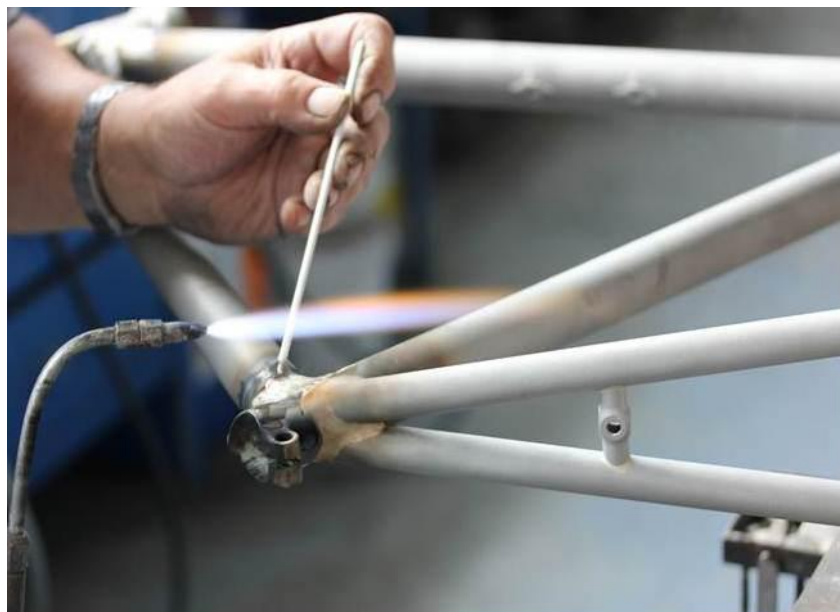
Slika 3: Lemljenje okvira bicikla plamenikom [7]
