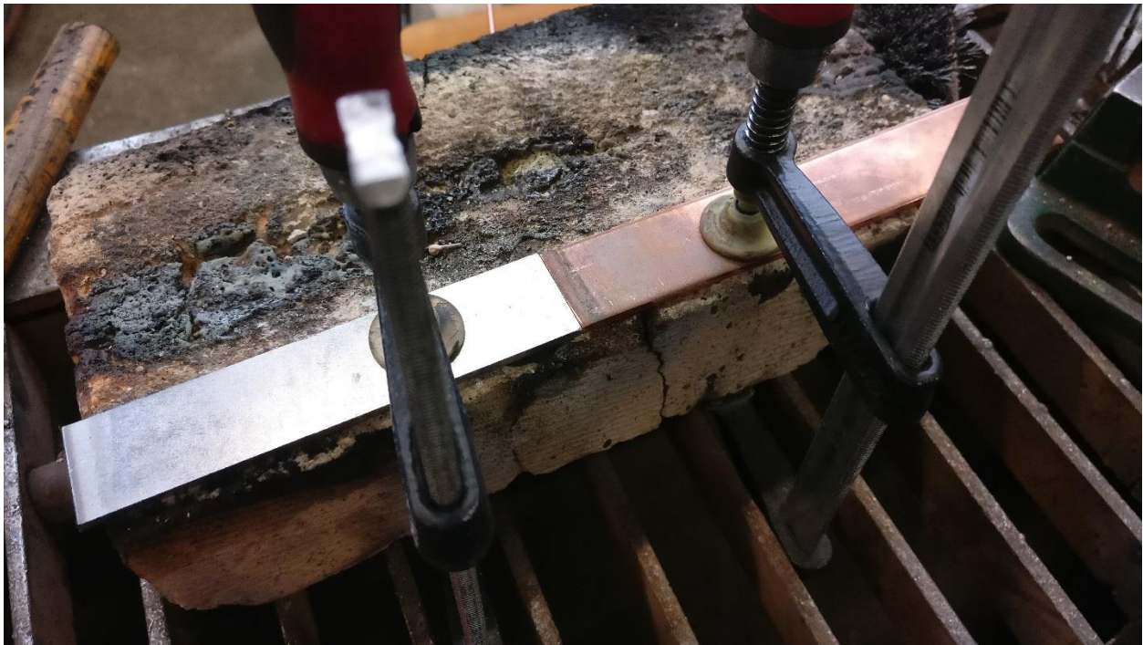
Slika 29: Priprema spoja za postupak lemljenje
