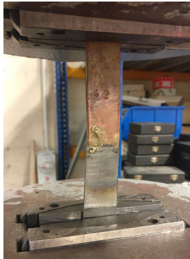
Slika 41: Uzorak u čeljustima kidalice (uzorak 42)
