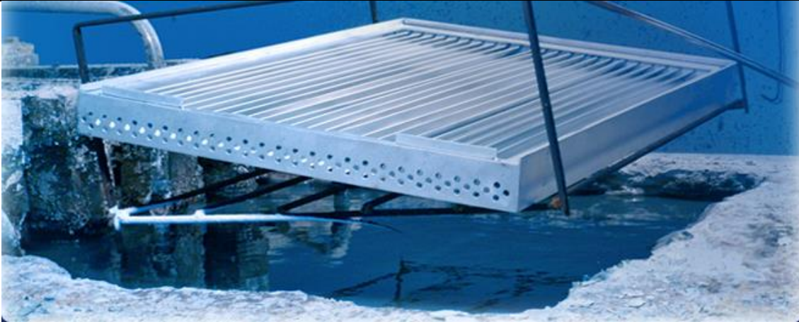
Slika 9: Uranjanje aluminijskih dijelova u rastaljeno talilo [13]
