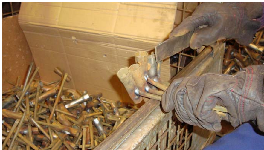
Sl. 28. Operacija čišćenja zavara
