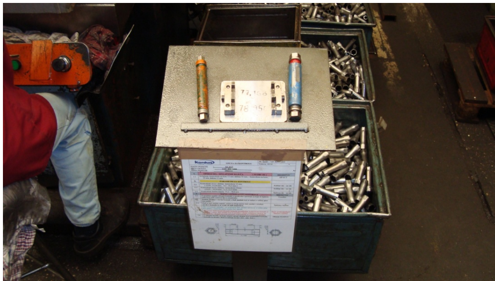
Sl. 11. Šablona kojom se kontrolira izvlačenje ključa
