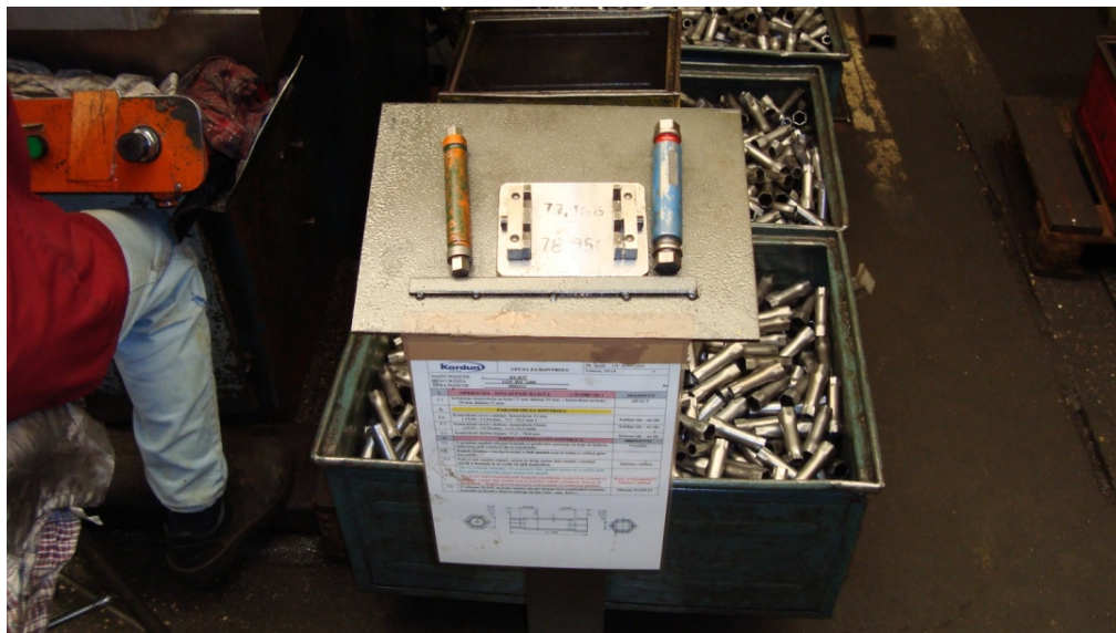
Sl. 11. Šablona kojom se kontrolira izvlačenje ključa
