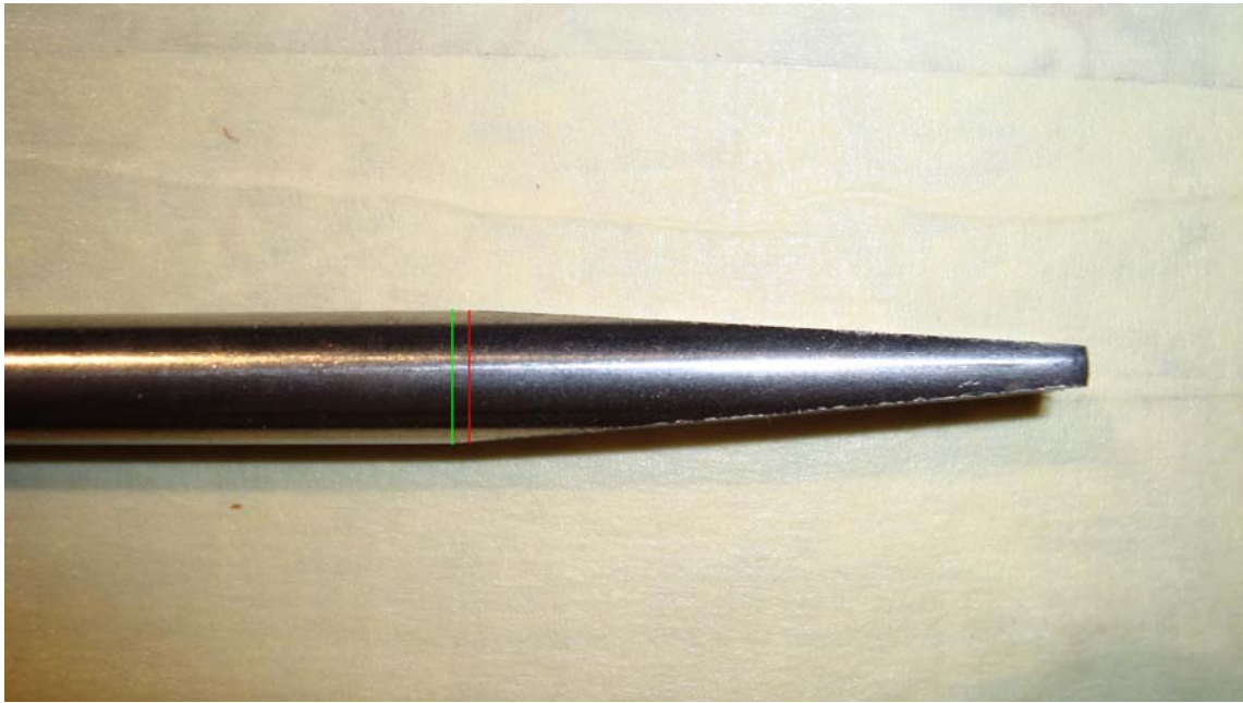
Sl. 57. Razlika u dužini kosine jedne i druge strane izvijača
