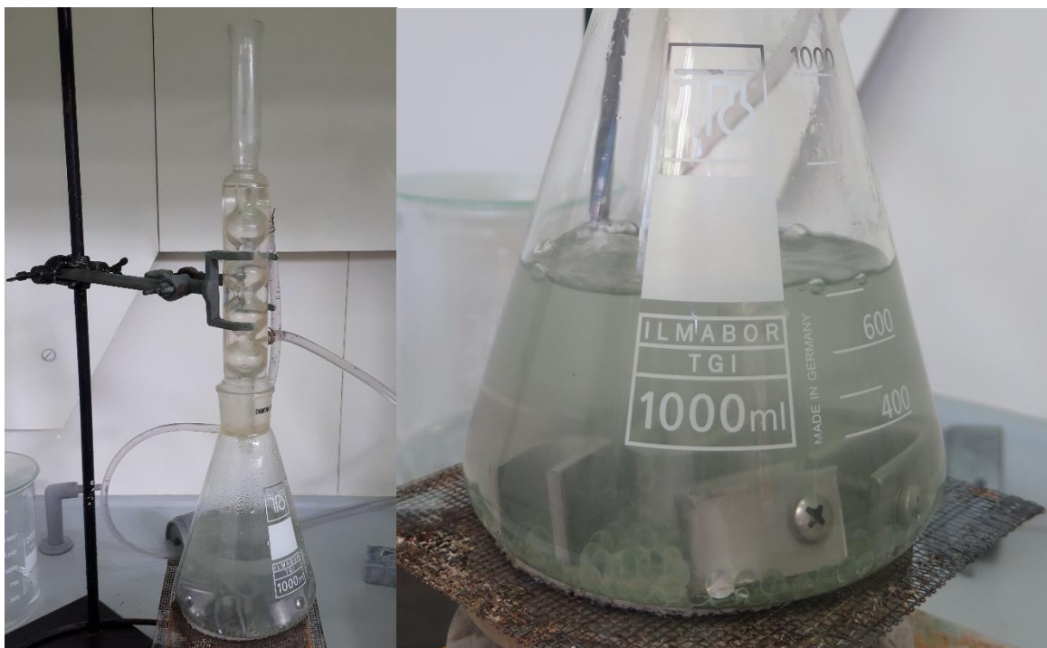
Slika 56: Ispitivanje uzoraka u 25 % otopini NaCl
