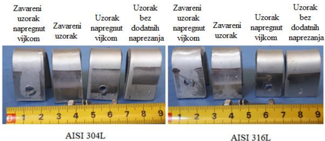
Slika 58: Uzorci nakon ispitivanja u ključajućoj otopini natrijeva klorida
