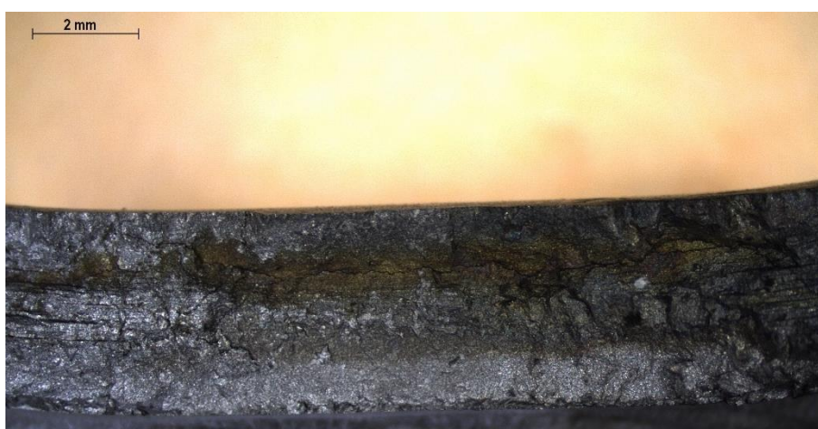
Uzorak AISI 316L zavaren i napregnut vijkom
