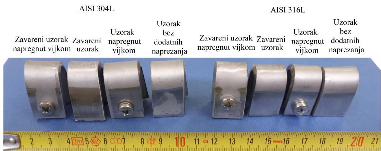
Slika 47: Skupina uzoraka za korozionsko ispitivanje
