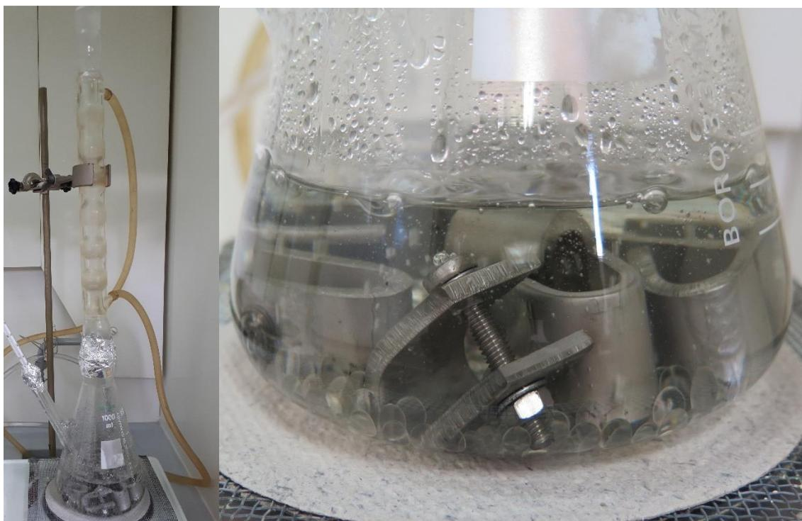
Slika 48: Ispitivanje uzoraka u ključajućoj 45 % otopini  $MgCl_2$
