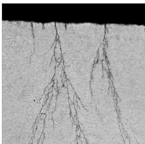
Slika 23: Kloridna napetosna korozija na čeliku 304L [24]
