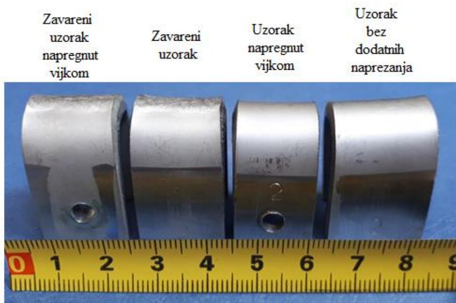
Slika 59: Vizualna kontrola uzorka čelika kvalitete AISI 316L
