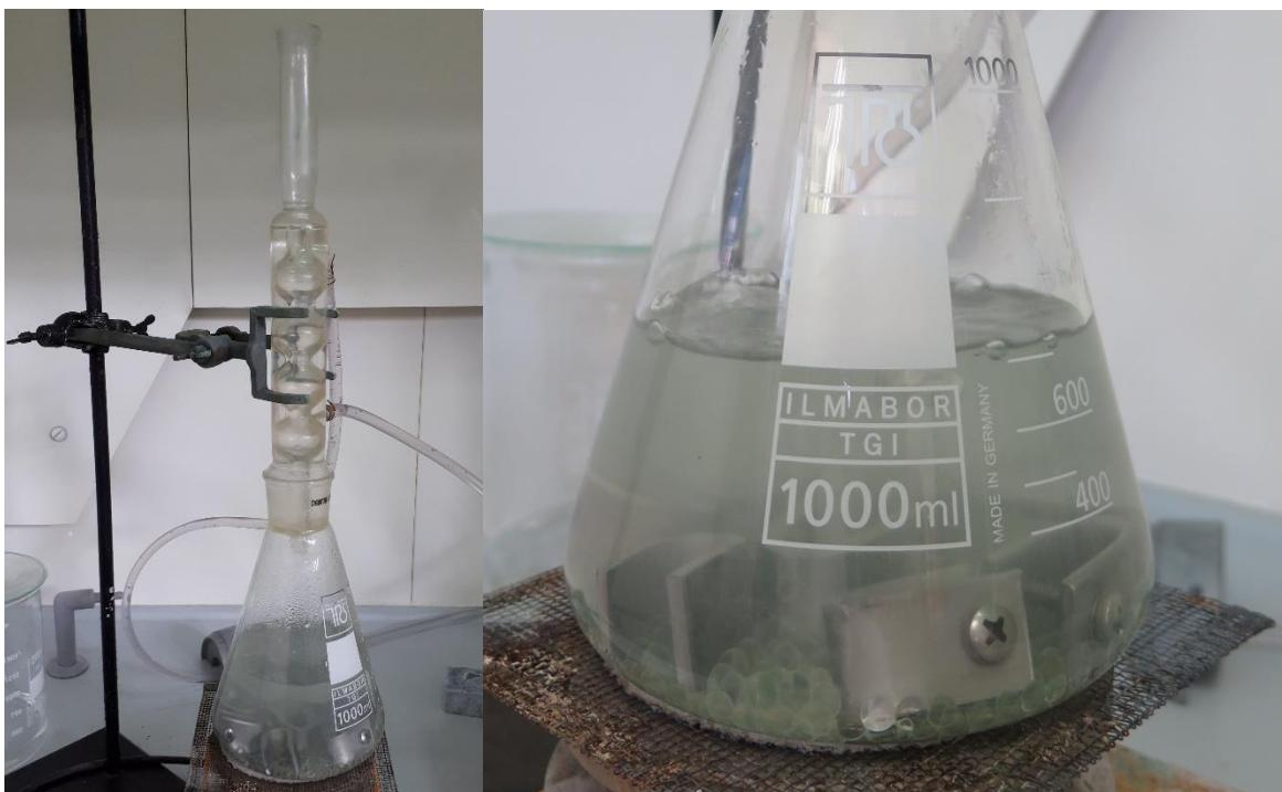
Slika 56: Ispitivanje uzorka u 25 % otopini NaCl
