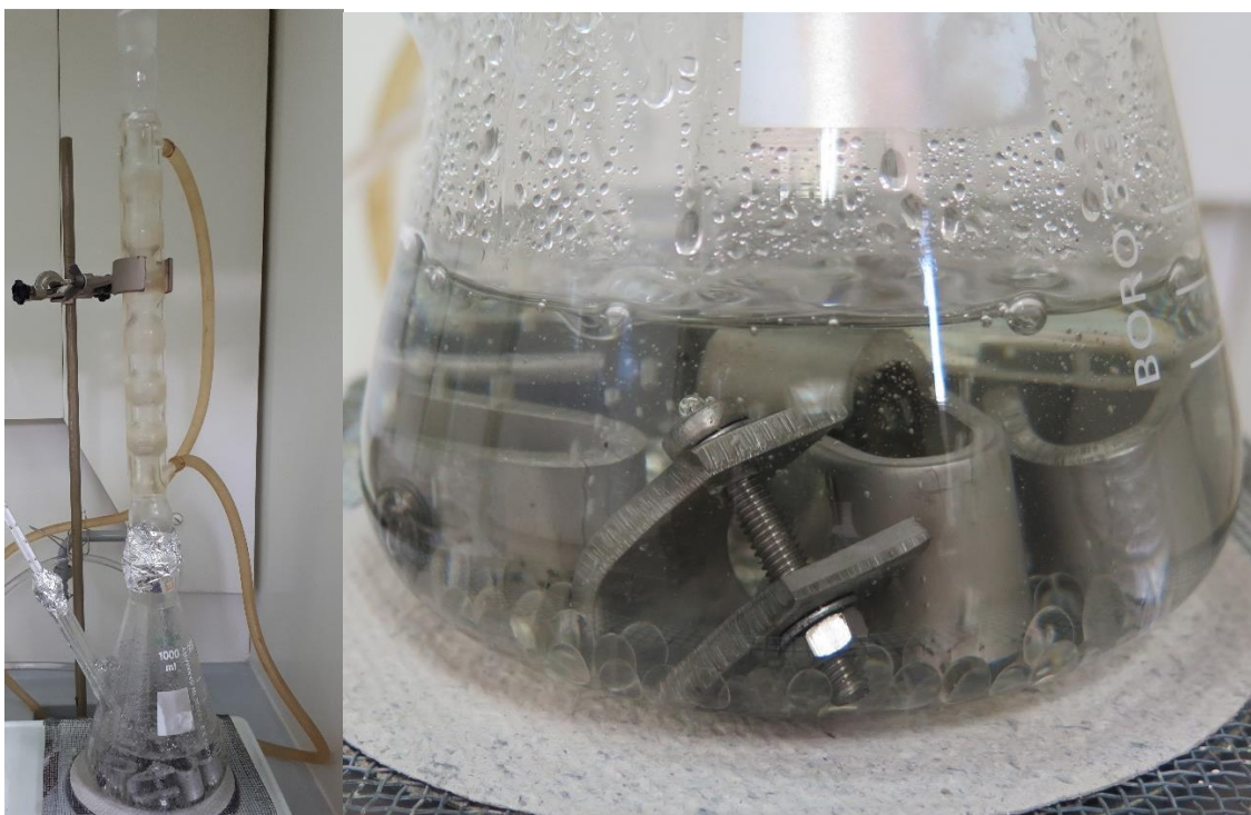
Slika 48: Ispitivanje uzoraka u ključajućoj 45 % otopini MgCl_2
