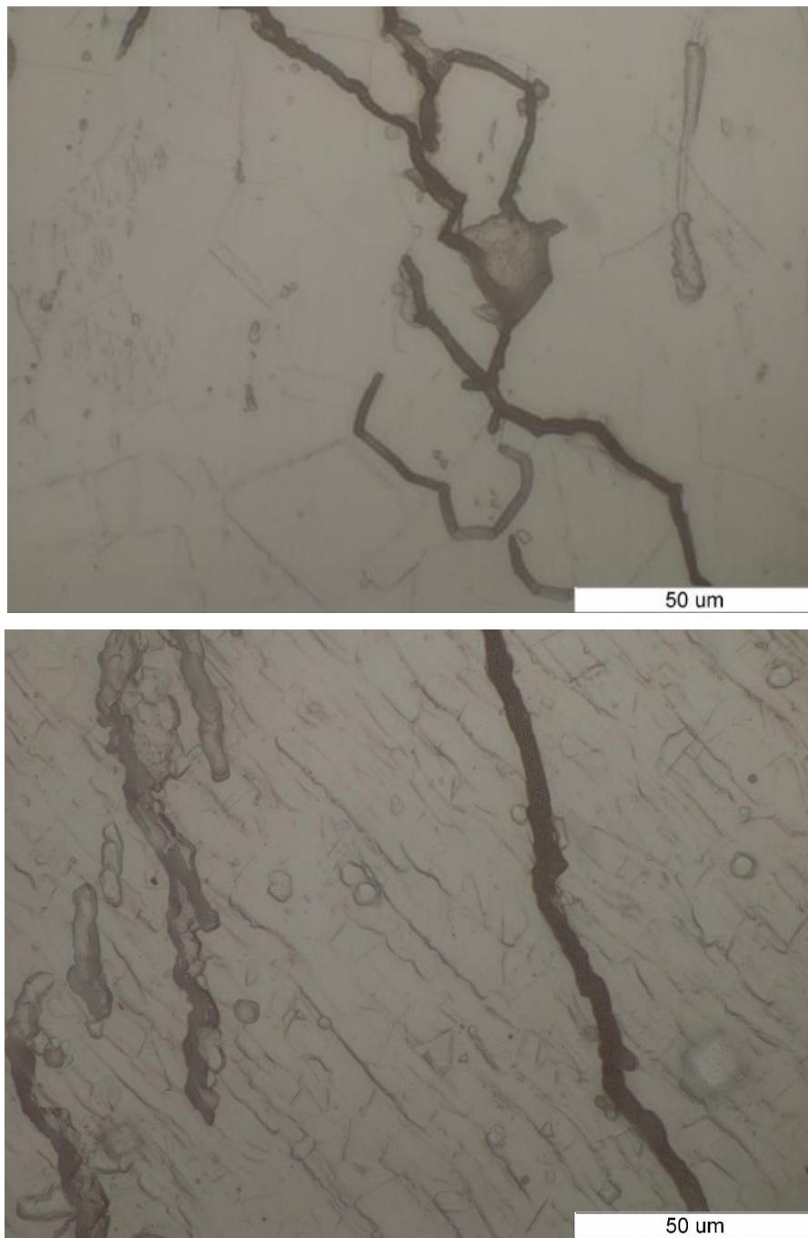
Slika 50: Mikrostrukturne snimke uzoraka čelika AISI 304L sa zavarom i narinutim naprezanjima s vidljivim interkristalnim karakterom napredovanja pukotine (gore) i uzorka od čelika AISI 316L sa zavarom s uočljivim transkristalnim mehanizmom razaranja (dolje)
