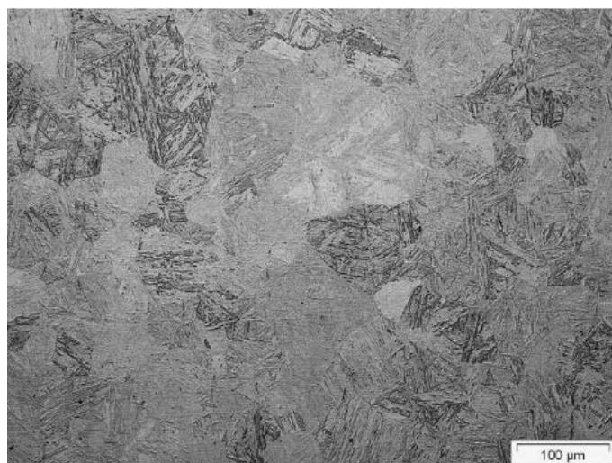
Slika 9: Mikrostruktura martenitnog nehrđajućeg čelika AISI 410 (EN 1.4003) [10]
