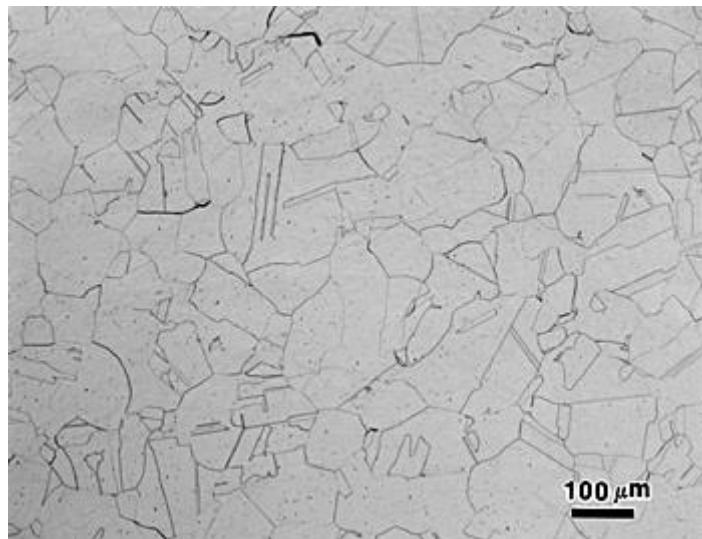
Slika 7: Mikrostruktura austenitnog čelika kvalitete AISI – 316 (EN 1.4401) [10]
