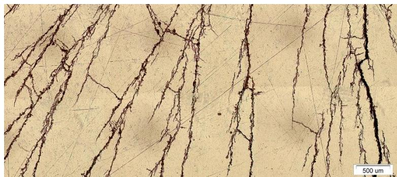
Slika 32: Uznapredovala transkristalna napetosna korozija [34]
