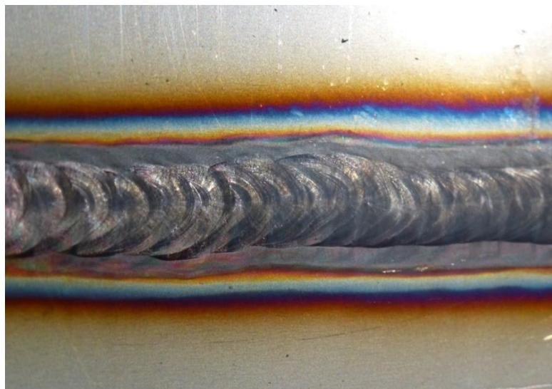
Slika 38: Toplinski oksidi nastali tijekom zavarivanja TIG postupkom
