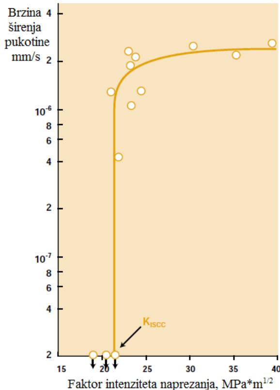
Slika 16: Brzina širenja pukotine u odnosu na faktor intenziteta naprezanja [19]
