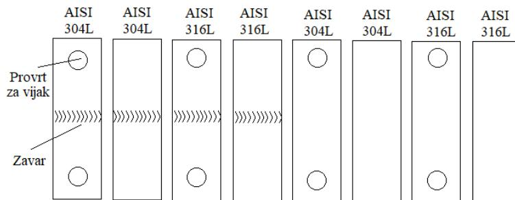
Slika 34: Shematski prikaz skupine uzoraka za ispitivanje
