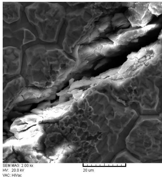
Slika 33: Transkristalna pukotina snimljena elektronskim pretražnim mikroskopom [34]
