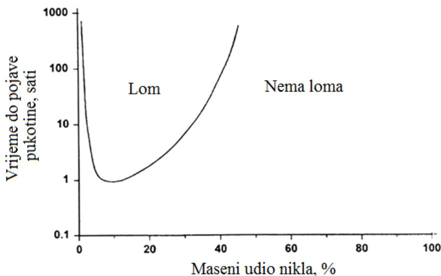
Slika 30: Učinak Ni na pojavu SCC kod čelika s 18 Cr u otopini MgCl<sub>2</sub> pri 154 °C [22]
