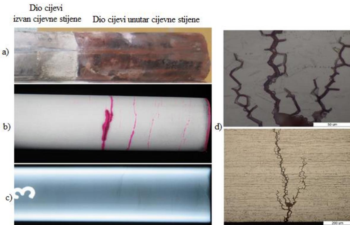
Slika 31: Prikaz oštećenja cijevi izmjenjivača topline:
