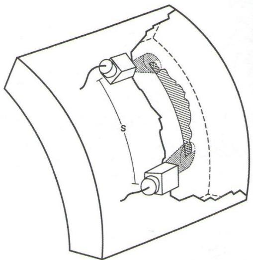
Slika 29: Ultrazvučno ispitivanje s dvije kutne sonde [13]
