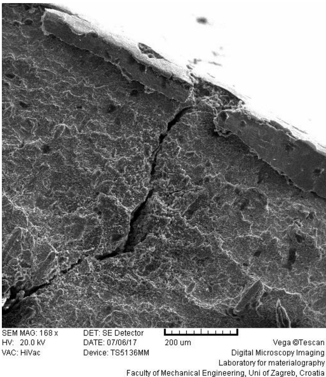
Slika 61: SEM snimka pukotine na uzorku čelika kvalitete AISI 304L bez dodatnih narinutih naprezanja
