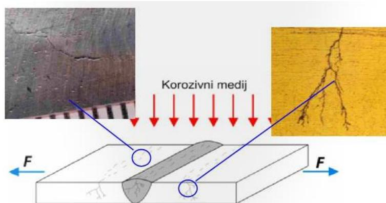
Slika 11: Lijevo - površina u kasnom stadiju napetosne korozije, desno – karakteristična transkristalna pukotina [15]
