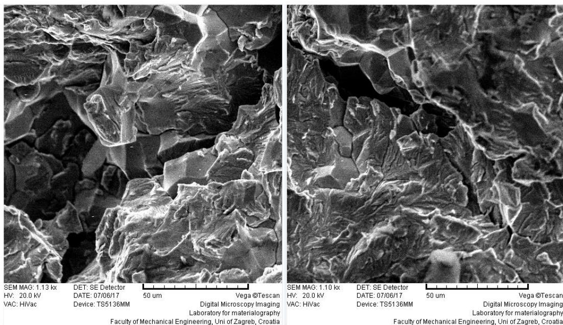
Slika 55: SEM snimke slomljenog vijka – transkristalni karakter oštećivanja
