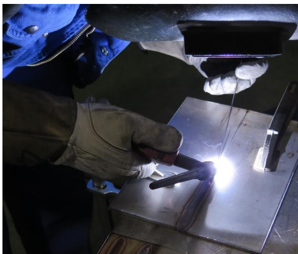
Slika 36: Prikaz provedbe TIG zavarivanja limova iz kojih su izrezani ispitni uzorci
