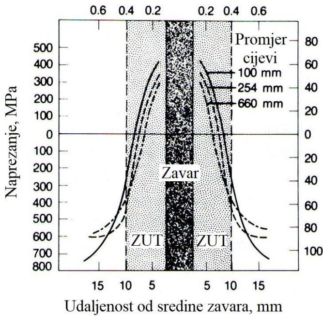
Slika 28: Zaostala naprezanja na zavarenim cjevima (AISI 304) različitim promjera [13]
