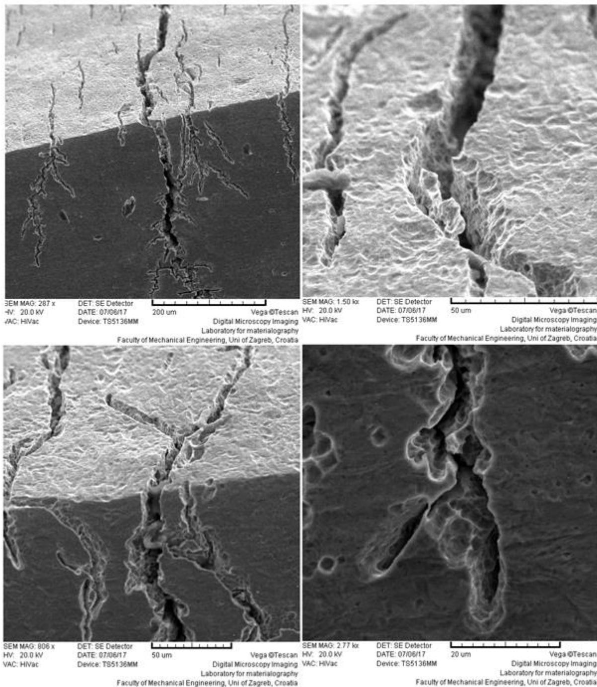
Slika 53: SEM snimke površine prijeloma – uzorak osnovnog materijala AISI 304L bez narinutog naprezanja – vidljive su mnogobrojne pukotine na površini koje se šire u dubinu materijala transkristalno
