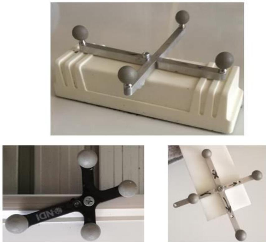
**Slika 17. Korišteni alati s pasivnim retroreflektivnim markerima**
