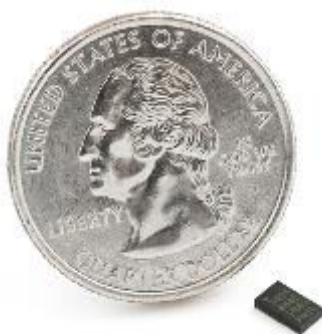
Slika 6. Akcelerometar ADXL 345 u usporedbi s kovanicom [2]
