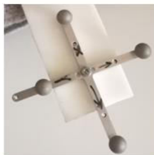
Slika 17. Korišteni alati s pasivnim retroreflektivnim markerima
