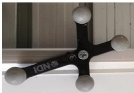
Slika 17. Korišteni alati s pasivnim retroreflektivnim markerima
