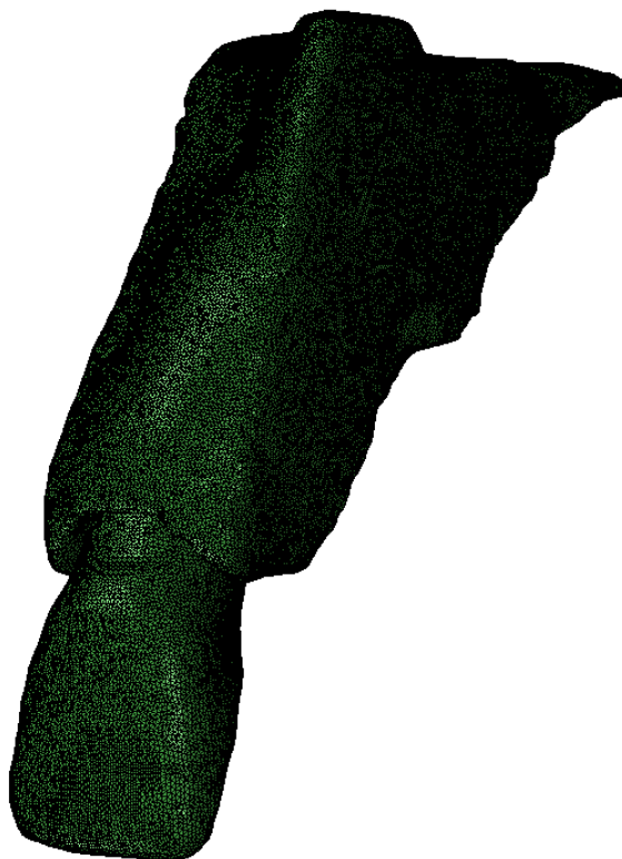
Slika 2.12 Mreža konačnih elemenata cijelog modela
