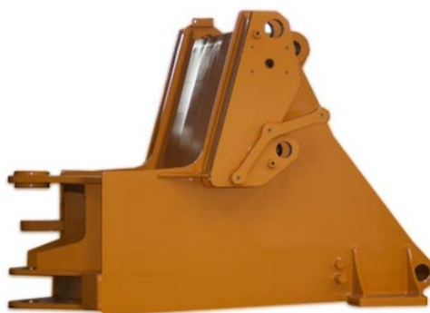
Slika 27. Reprezentantni proizvod: prednji dio okvira utovarivača [14]
