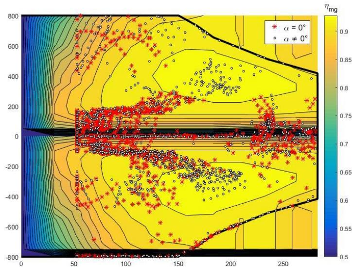
*Slika 30. Optimalne radne točke ES dobivene DP optimiranjem kod hibridnog električnog pogona dobivene za snimljeni vozni ciklus za slučajeve bez učitanog nagiba i s učitanim promjenjivim nagibom*
