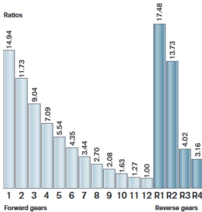
Slika 2. Stupnjevi prijenosa automatske transmisije Volvo AT2412D I-Shift [5]
