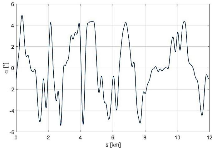
Slika 17. Prikaz rekonstruiranog nagiba ceste iz snimljenih podataka
