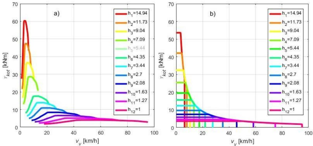
Slika 5. Maksimalni moment na kotaču za različite stupnjeve prijenosa za a) SUI motora i b) ES [4]
