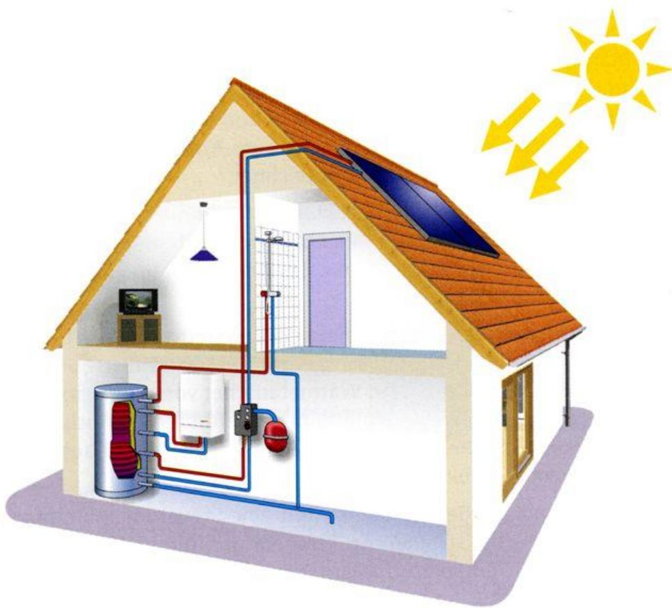
Slika 3. Solarni sustavi za pripremu potrošne tople vode [1]
