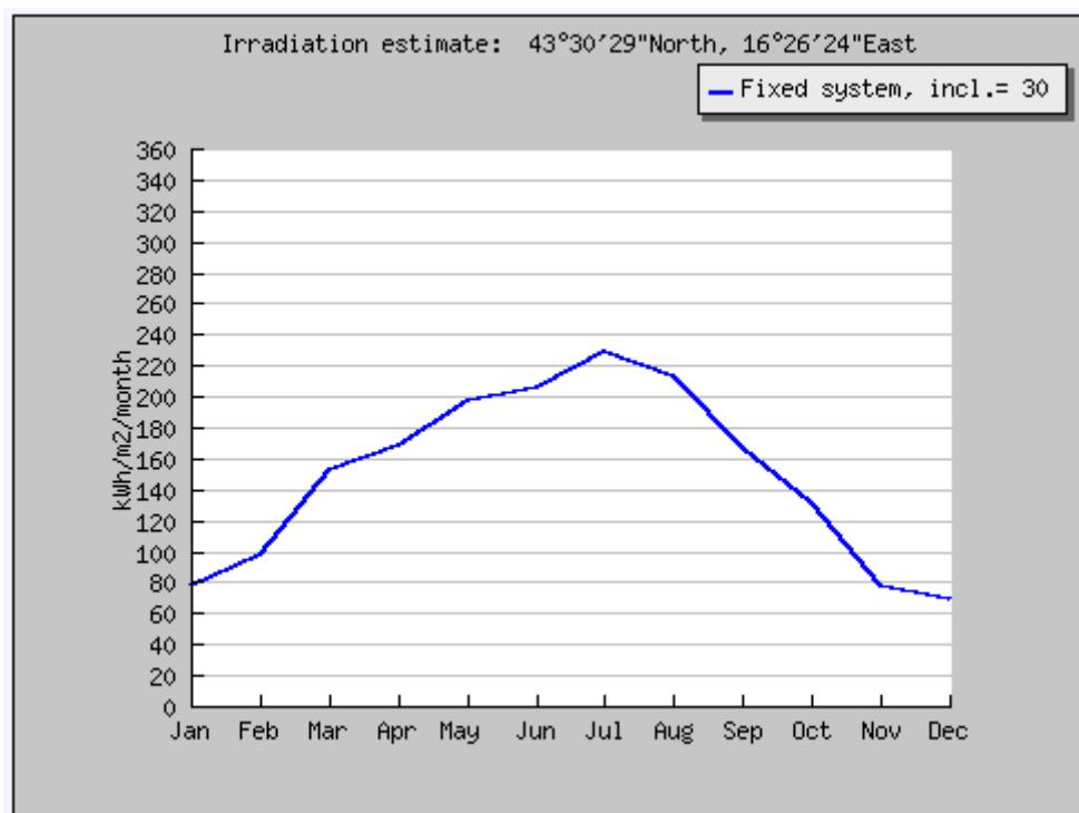
Slika 22. Mjesečna proizvodnja električne energije po m<sup>2</sup> fotonaponskog sustava ukupne snage 5 kWp instaliranog na obiteljskoj kući u Gradu Zagrebu
