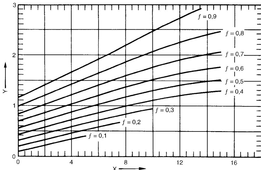
Slika 12.  $f$ -dijagram za solarne sustave s kolektorima s tekućim nosiocem topline
