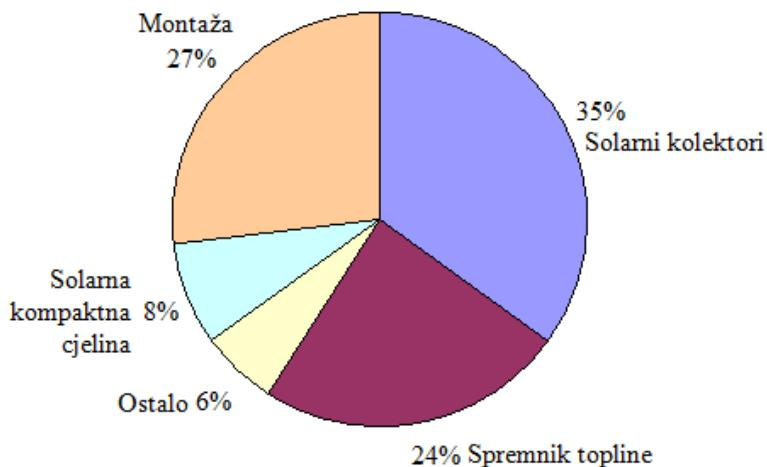
**Slika 4. Udjeli troškova ugradnje solarnog sustava za pripremu potrošne tople vode kućanstva s jednom do dvije obitelji [1]**
