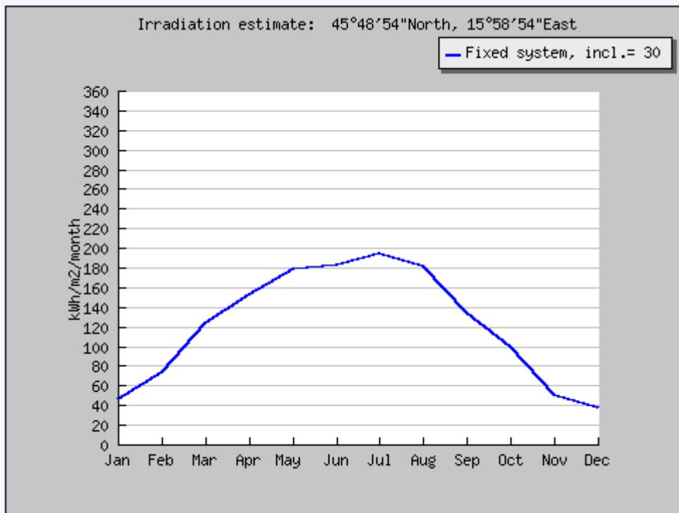
Slika 19. Mjesečna proizvodnja električne energije po  $\text{m}^2$  fotonaponskog sustava ukupne snage 5 kWp instaliranog na obiteljskoj kući u Gradu Zagrebu
