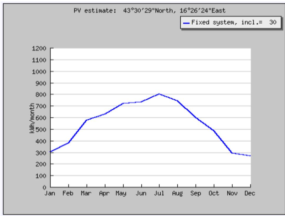
Slika 21. Mjesečna proizvodnja električne energije iz fotonaponskog sustava ukupne snage 5 kWp instaliranog na obiteljskoj kući u Gradu Splitu
