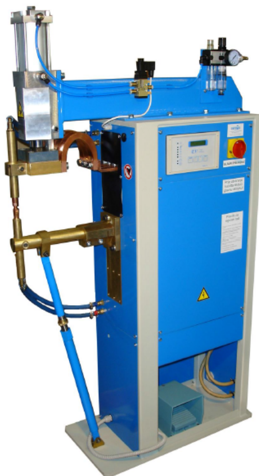
Slika 11: SERVUS Tv-30PK uređaj za elektrootporno zavarivanje
