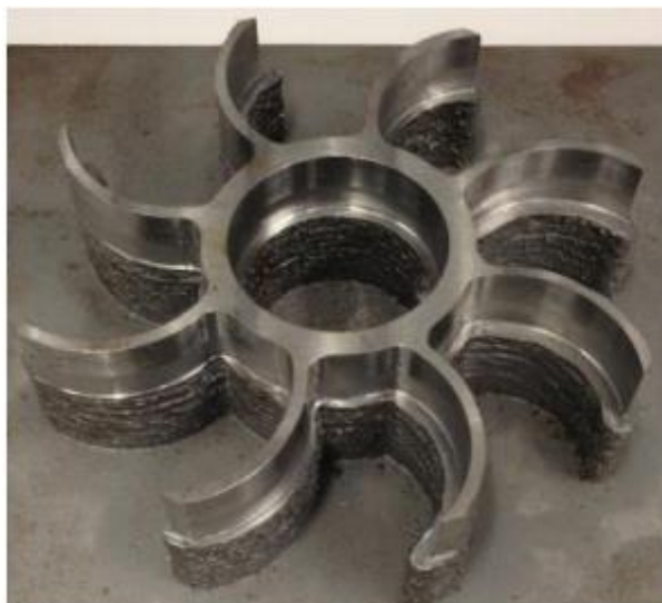
Slika 24. Rotor izrađen WAAM postupkom [28]
