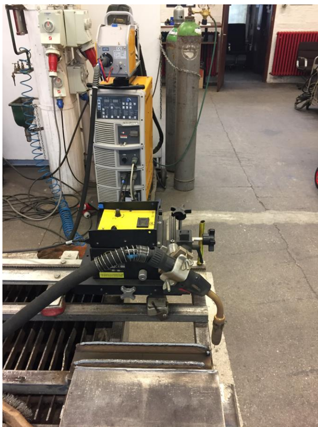
Slika 30. Oprema za WAAM postupak zavarivanja [31]
