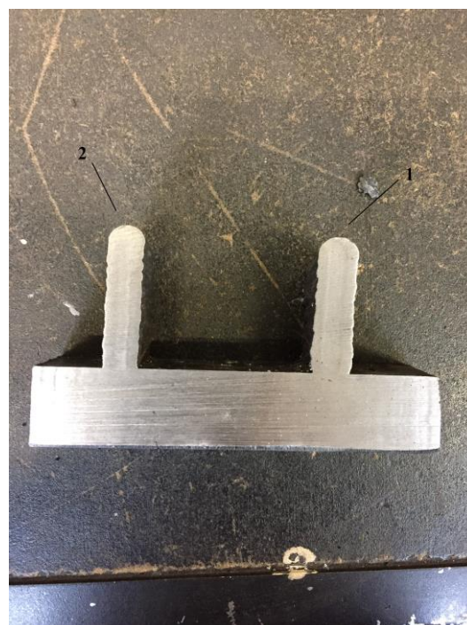
Slika 53. i slika 54. Prikaz krajeva uzoraka 1 i 2 pripremljenih za makroanalizu [31]
