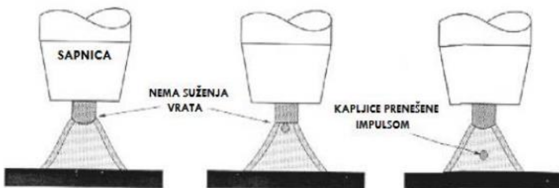
Slika 11. Shematski prikaz prijenosa metala impulsnim lukom [14]
