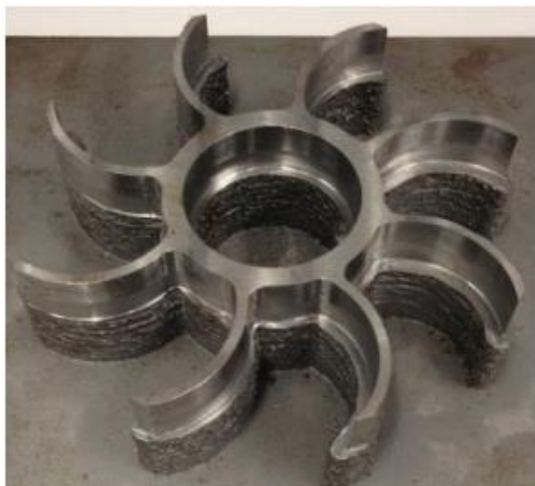
Slika 24. Rotor izrađen WAAM postupkom [28]
