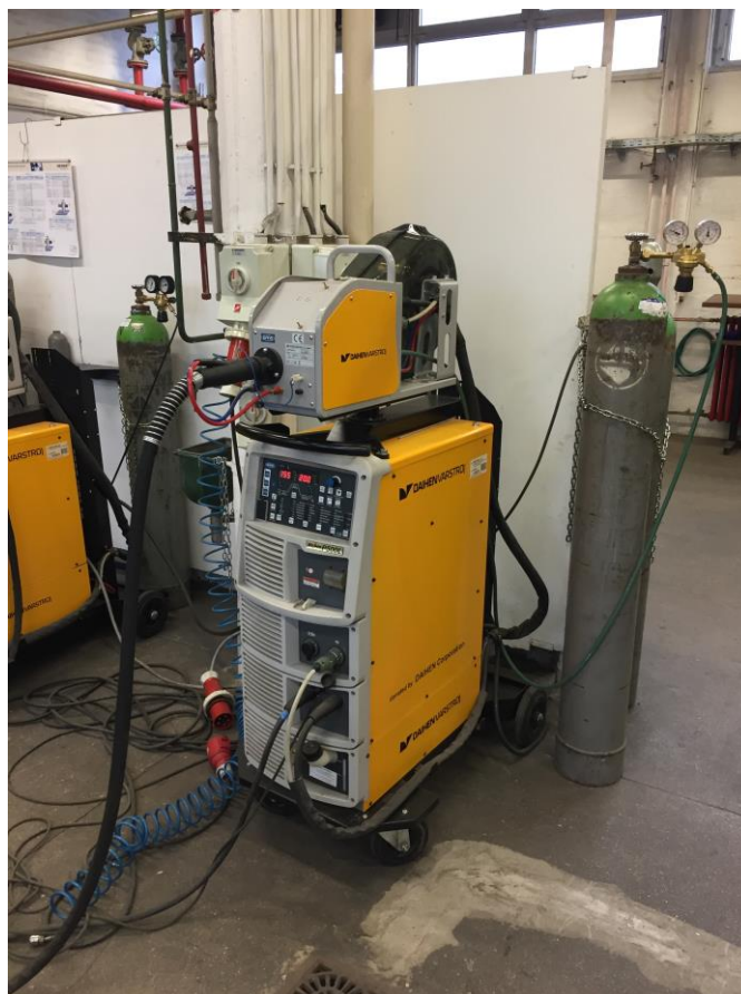
Slika 31. Izvor struje Welbee P500L [31]
