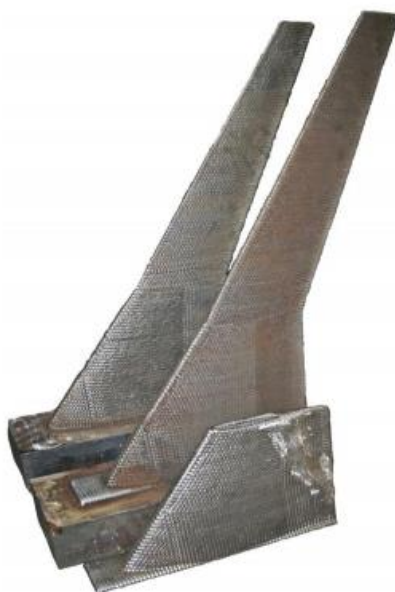
Slika 25. Model krila izrađen WAAM postupkom [26]
