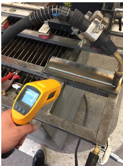
Slika 37. Mjerenje temperature međuprolaza [31]
