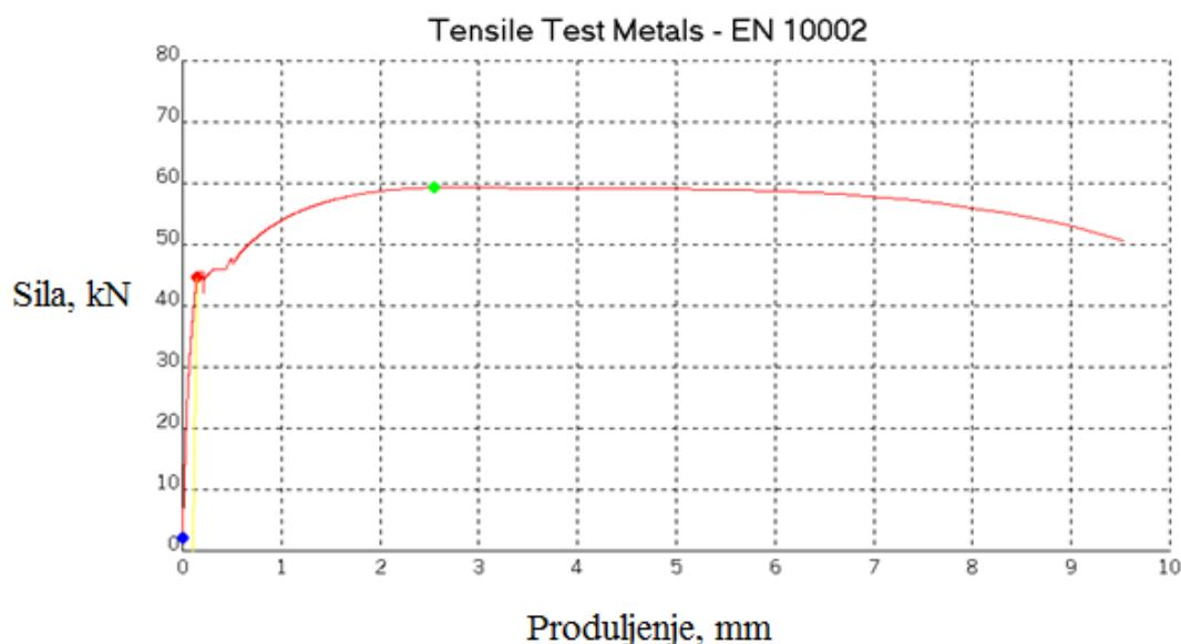
**Slika 73. Dijagram naprezanja za uzorak 2 [31]**
