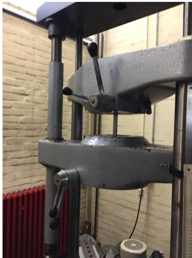
Slika 69. Kidalica i uzorak 1 postavljen za testiranje [31]
