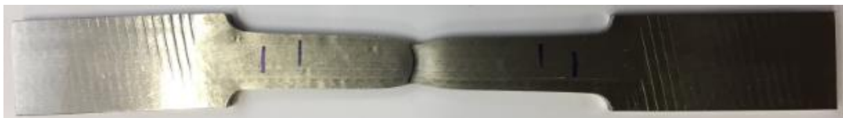
Slika 70. Uzorak 1 nakon testiranja [31]
