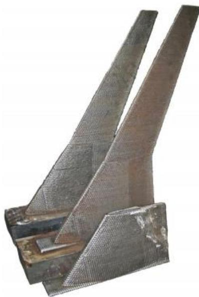
**Slika 25. Model krila izrađen WAAM postupkom [26]**
