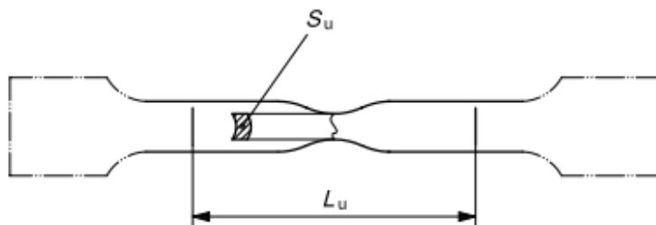
**Slika 67. Dimenziije ispitnih epruveta nakon testiranja [34]**
