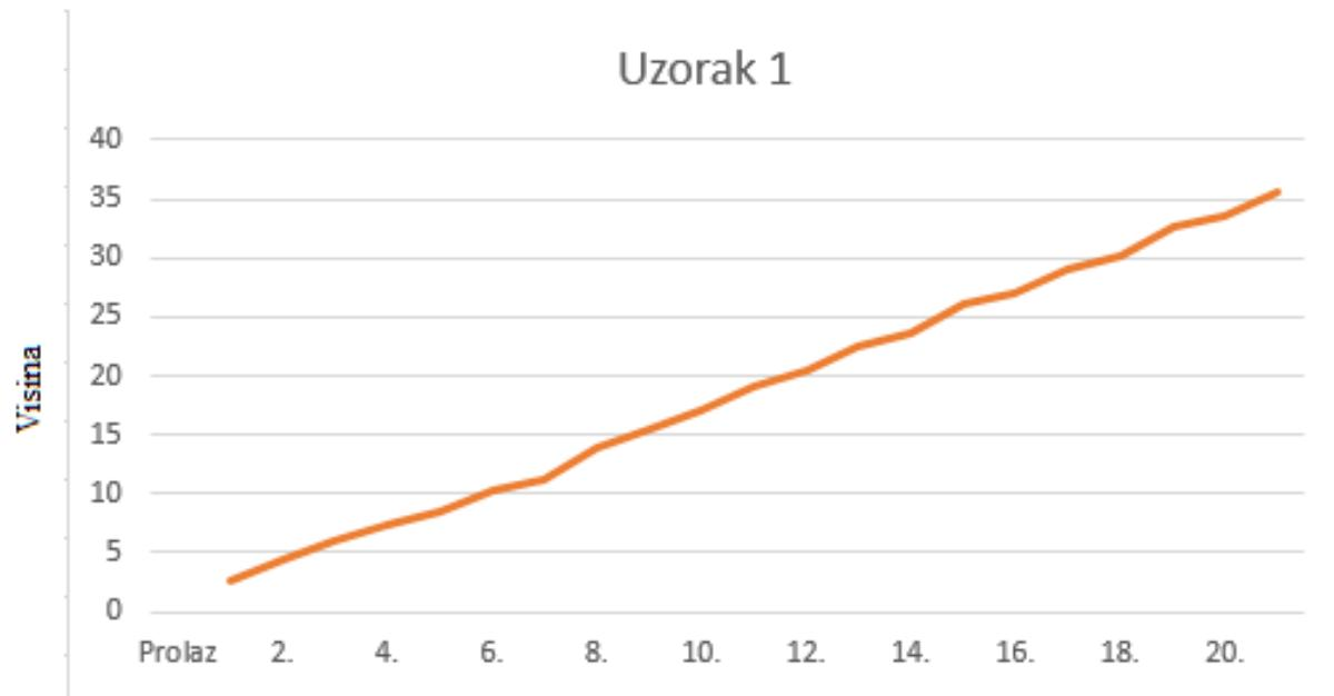
**Slika 38. Mjerenje visine zavara – uzorak 1**
