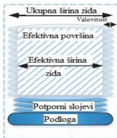
Slika 21. Zid izrađen WAAM postupkom [24]
