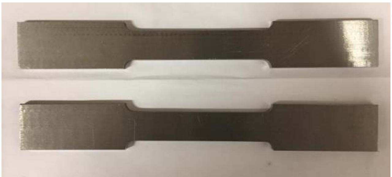
**Slika 68. Ispitne epruvete (uzorak 1 – gornja, uzorak 2 – donja) [31]**
