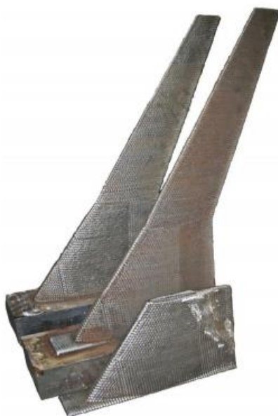
Slika 25. Model krila izrađen WAAM postupkom [26]
