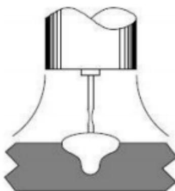
Slika 7. Shematski prikaz prijenosa metala kratkim spojem [12]
