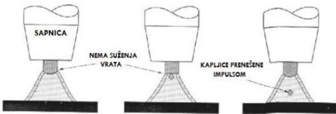
**Slika 11. Shematski prikaz prijenosa metala impulsnim lukom [14]**
