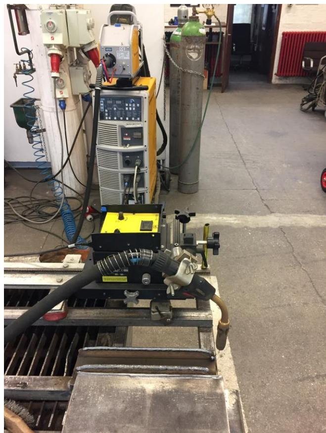
Slika 30. Oprema za WAAM postupak zavarivanja [31]
