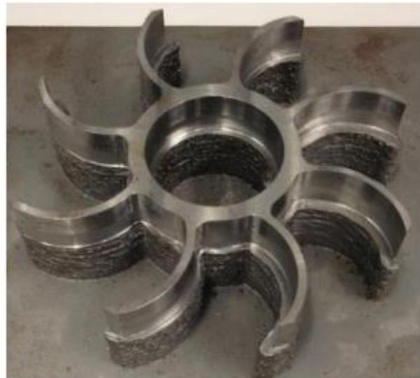
**Slika 24. Rotor izrađen WAAM postupkom [28]**
