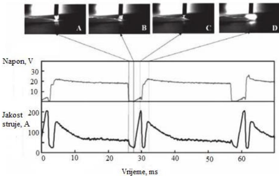
Slika 14. Faze CBT prijenosa metala snimljene visokobrzinskom kamerom [17]
