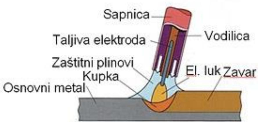
Slika 1. Shematski prikaz MAG postupka zavarivanja [4]
