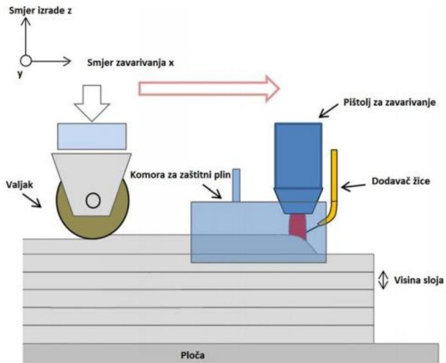
Slika 22. Osnovna i dodatna oprema za WAAM postupak [25]
