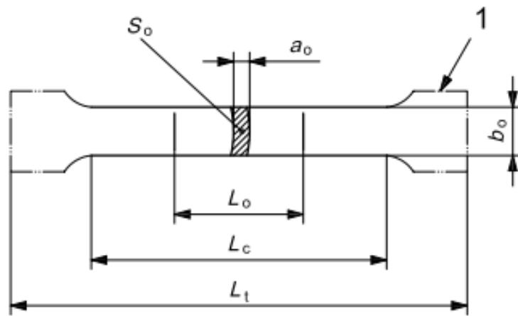
**Slika 66. Dimenziije ispitnih epruveta prije testiranja [34]**
