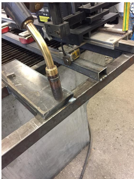
Slika 35. i slika 36. Prikaz načina na koji je pričvršćen osnovni materijal na radnu ploču [31]
