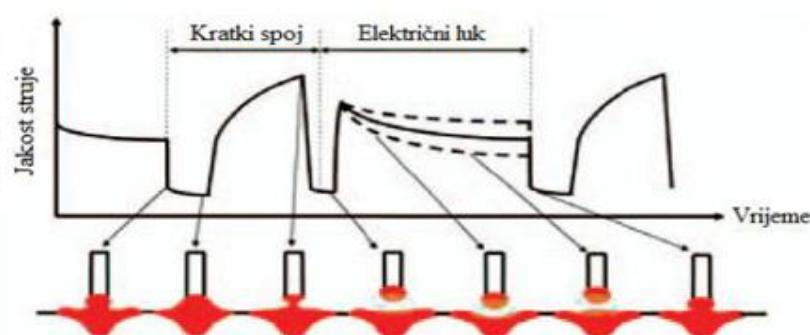
Slika 12. Princip CBT MAG postupka zavarivanja [15]
