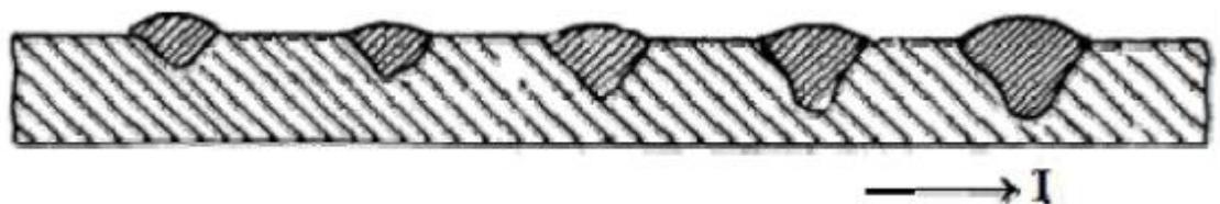
Slika 3. Utjecaj jakosti struje zavarivanja na geometriju zavara [7]
