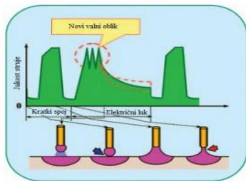
Slika 17. Princip rada CBT – EX MAG postupka zavarivanja [18]
