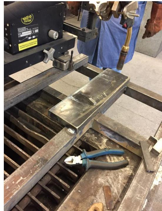
**Slika 35. i slika 36. Prikaz načina na koji je pričvršćen osnovni materijal na radnu ploču [31]**
