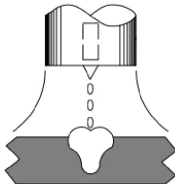
Slika 10. Shematski prikaz prijenosa metala štrcajućim lukom [12]
