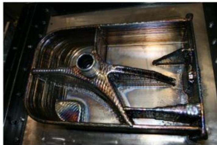
**Slika 26. Dio velike složenosti izrađen WAAM postupkom [29]**
