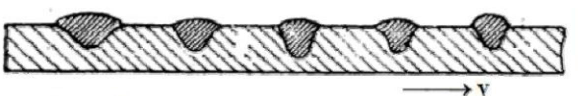
**Slika 5. Utjecaj brzine zavarivanja na oblik zavara [7]**
