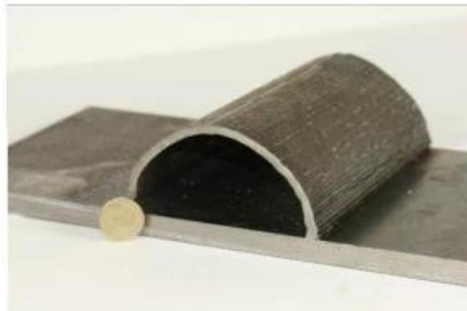
**Slika 27. Polukružna konstrukcija izvedena WAAM postupkom [28]**
