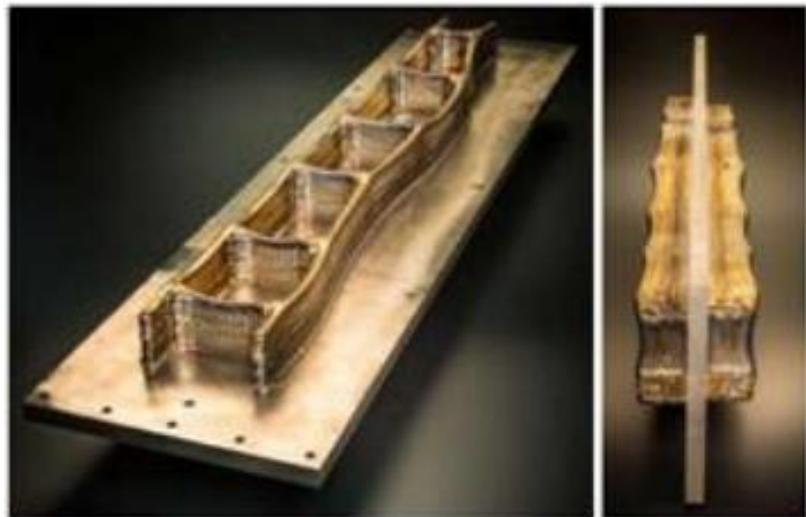
**Slika 28. Potporna konstrukcija krila zrakoplova od Ti6Al4V [30]**
