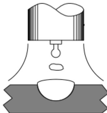
Slika 9. Shematski prikaz prijenosa metala prijelaznim lukom [12]
