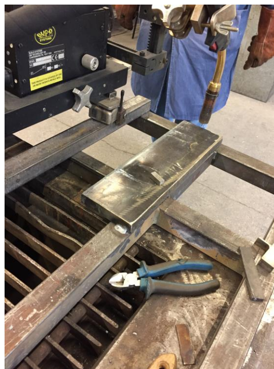
Slika 35. i slika 36. Prikaz načina na koji je pričvršćen osnovni materijal na radnu ploču [31]
