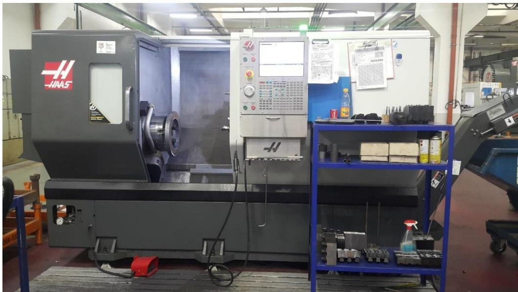
Slika 9.13. CNC obradni centar *Haas ST-35*
