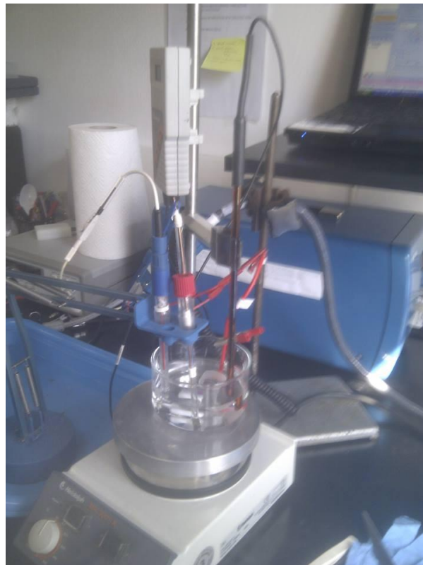
Slika 9.10. Ispitna oprema za elektrokemijska AC ispitivanja
