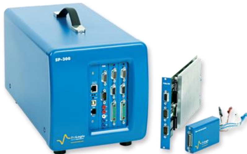
Slika 9.11. Potenciostat/Galvanostat BioLogic SP-300 [26]
