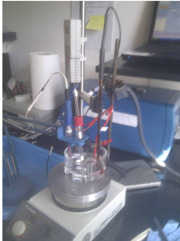
Slika 9.10. Ispitna oprema za elektrokemijska AC ispitivanja
