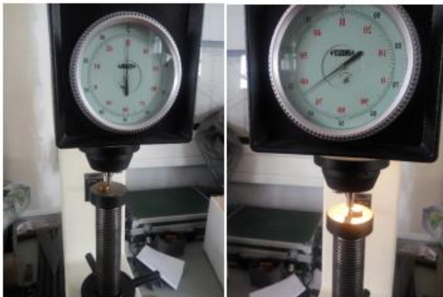
Slika 6.1. Ispitivanje adhezivnosti na Rockwell-ovom tvrdomjeru [18]
