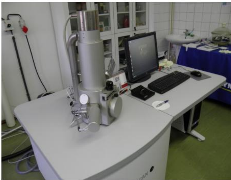
Slika 5.2. Skenirajući elektronski mikroskop [19]
