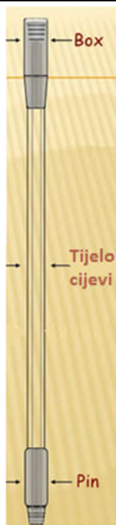
Slika 10 Karakteristične značajke na cijevi za bušenje
