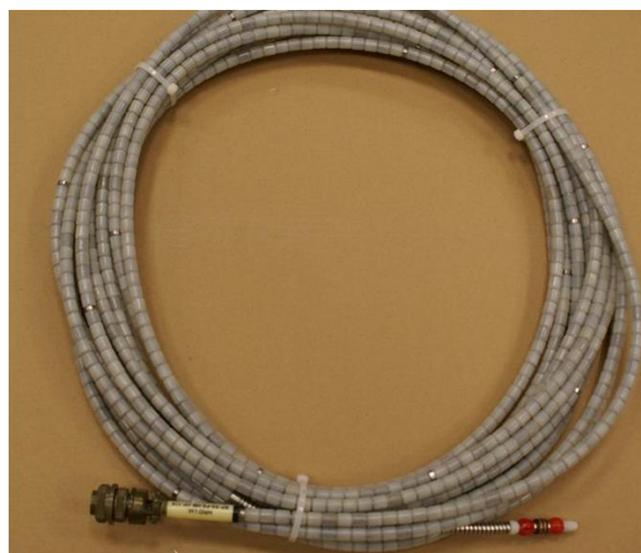
Slika 9. Sklop ELN i sonde za ECT sa Bobbin sondom [9]
