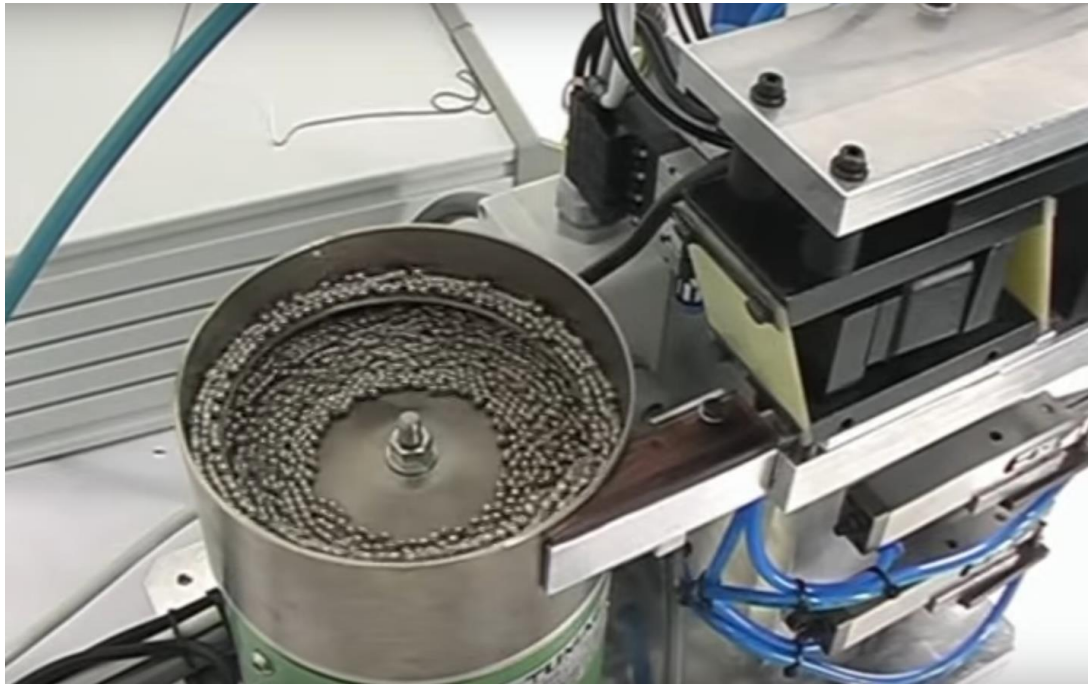
Slika 11. Dobava i usmjeravanje perli u Ciemmeov uređaj
