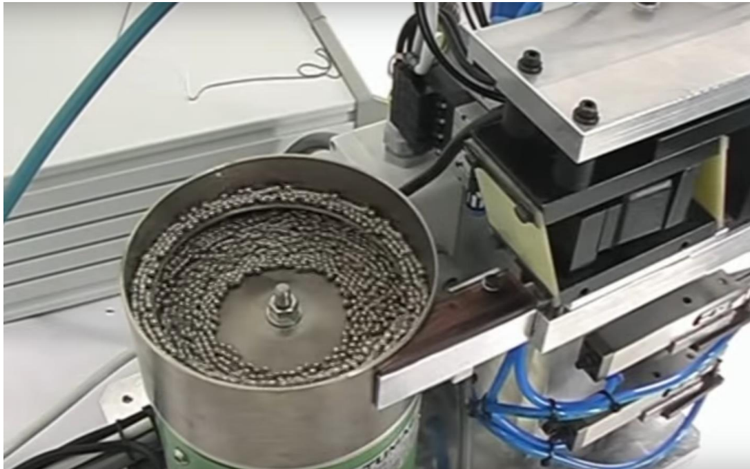
Slika 11. Dobava i usmjeravanje perli u Ciemmeov uređaj
