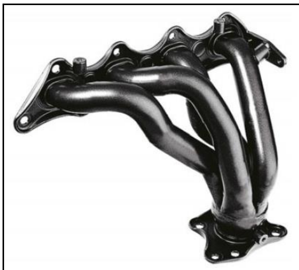
Slika 2.3 Ispušna grana izrađena od čeličnih cijevi [4]
