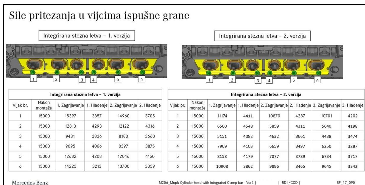
**Slika 5.30** Prikaz simulacije raspodjele sile pritezanja (usporedba 1. i 2. verzije konstrukcije)
