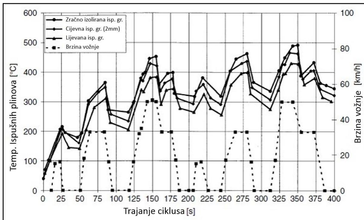
**Slika 2.6 Usporedba temperature ispušnih plinova atmosferskog motora za različite izvedbe ispušne grane [2]**
