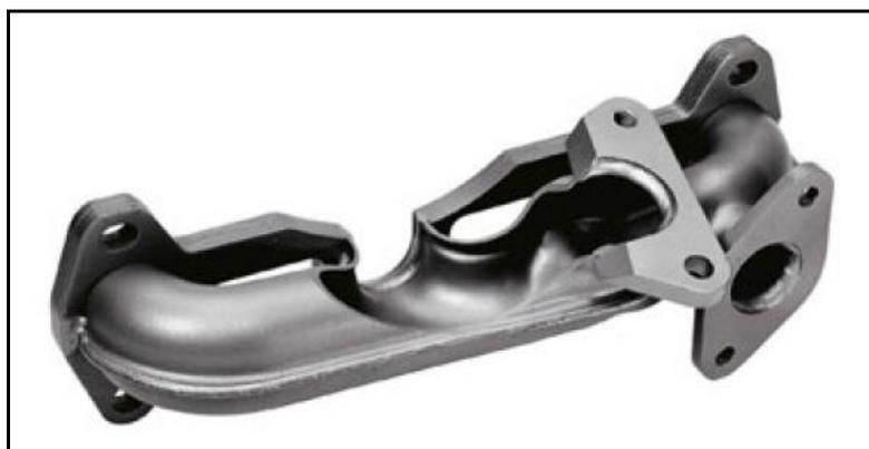
Slika 2.4 Ispušna grana izrađena od čeličnih limova [4]
