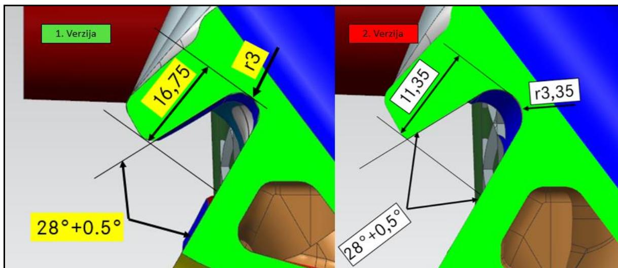
Slika 5.23 Kontura integrirane stezne letve u glavi motora - usporedba 1. i 2. verzije
