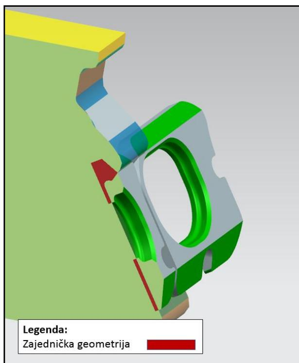
Slika 5.4 Konstrukcija konture integrirane stezne letve
