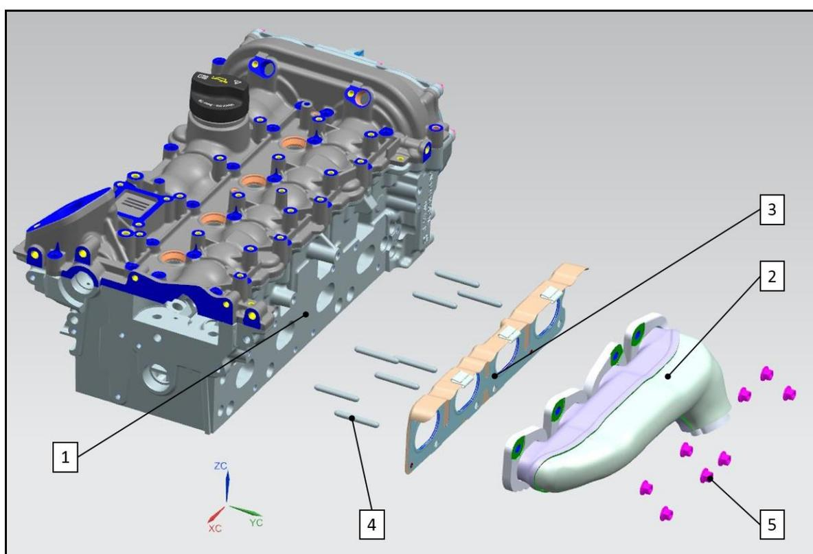
**Slika 2.14 Izravan spoj ispušne grane vijcima na glavu motora**
