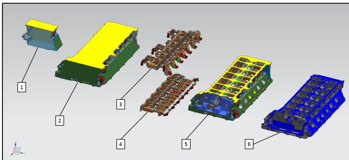
**Slika 5.1 Struktura 3D-CAD modela glave M256 motora**
