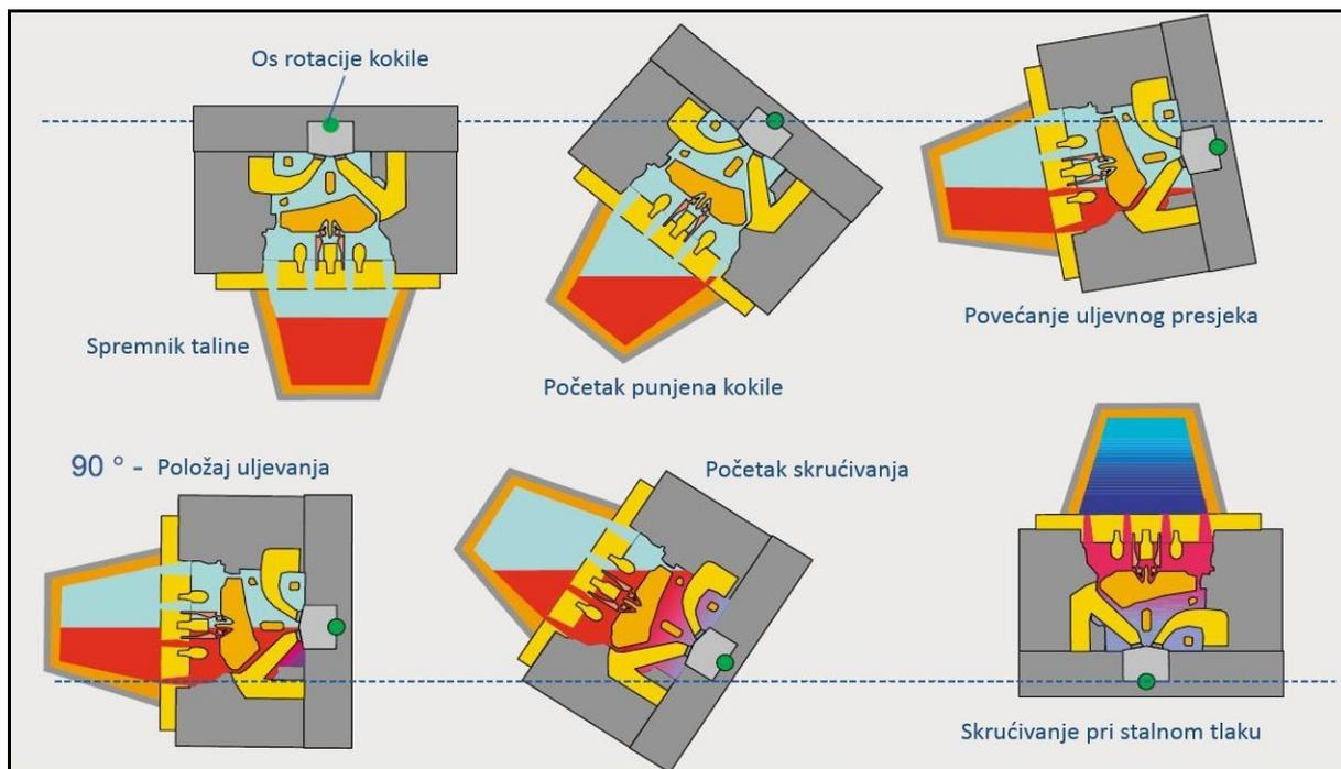
**Slika 5.12 Shematski prikaz ROTACAST® postupka lijevanja glave motora**
