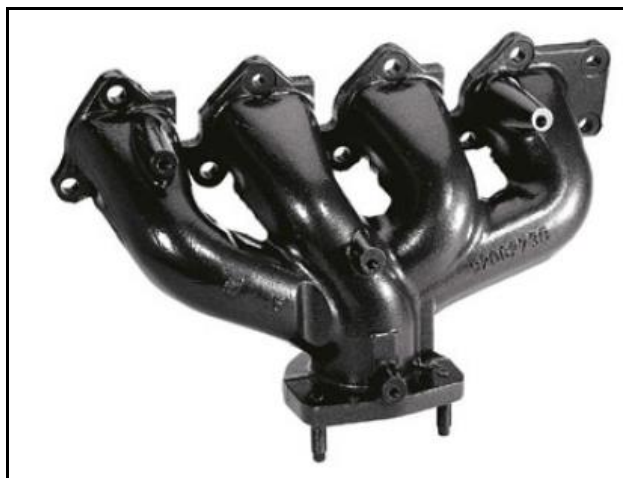
Slika 2.2 Ispušna grana izrađena od čeličnog lijeva [4]
