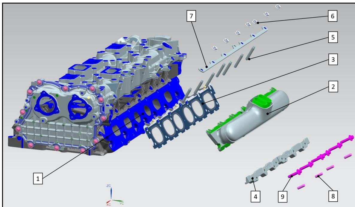
**Slika 2.15 Spoj ispušne grane pomoću odvojive stezne letve**
