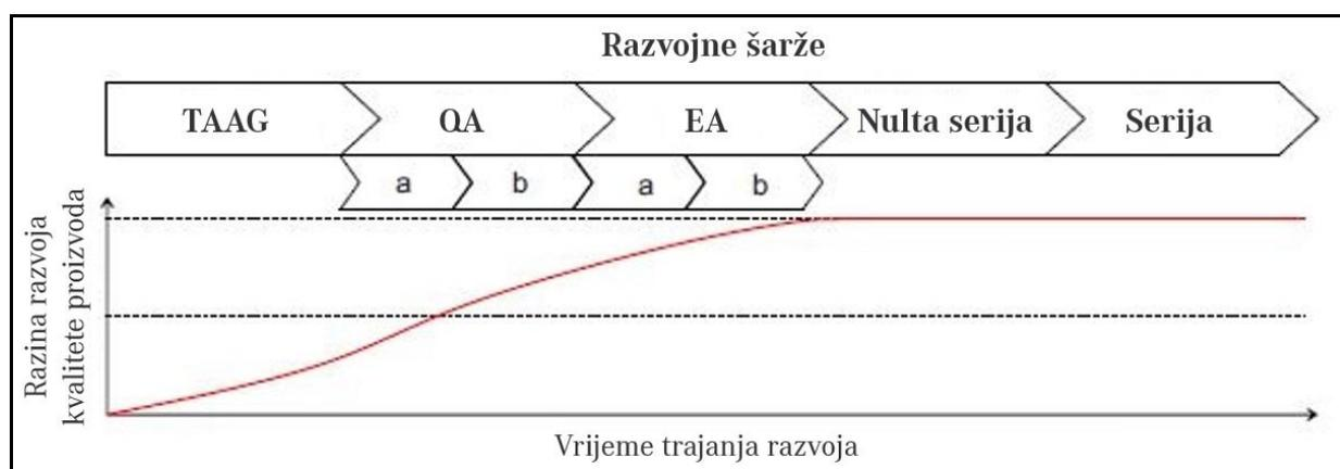
Slika 3.1 Tok razvojnih šarži Mercedes-Benz motora [8]
