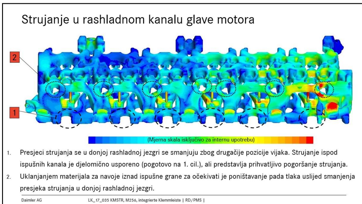
**Slika 5.32 Prikaz simulacije strujanja u rashladnom kanalu glave motora
