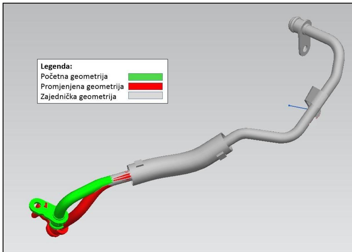
**Slika 5.28 Cijev povrata rashladne tekućine iz turbopunjača**
