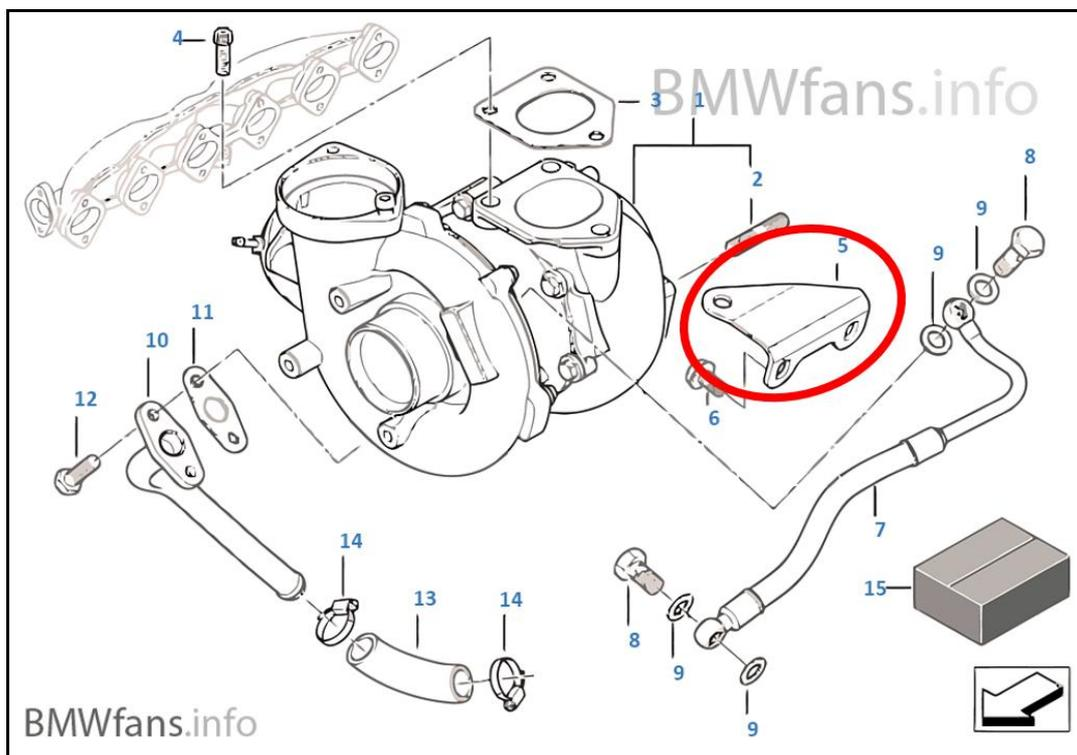
**Slika 2.12 Nedovoljno dimenzionirana limena potpora turbopunjača [6]**
