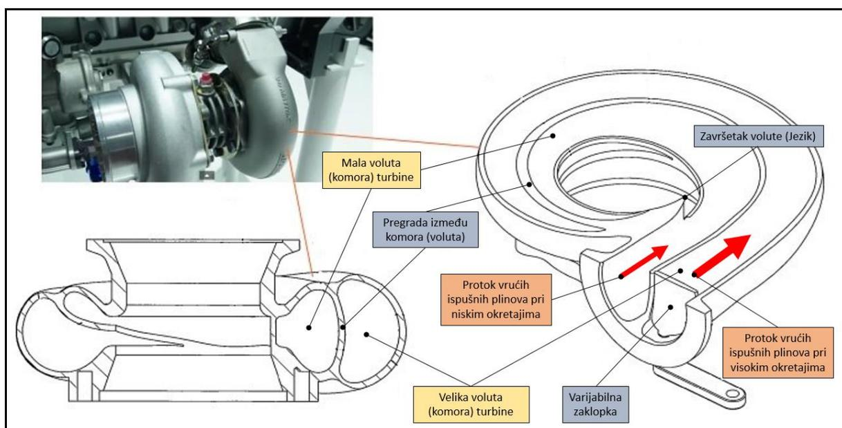
**Slika 2.8 Prikaz kućišta turbine ispušnog turbopunjača u presjeku [5]**
