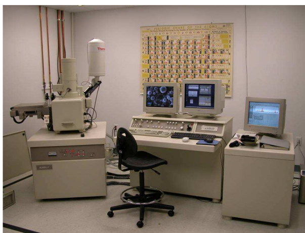
Slika 1.19. SEM sustav laboratorija za materijalografiju FSB-a.
