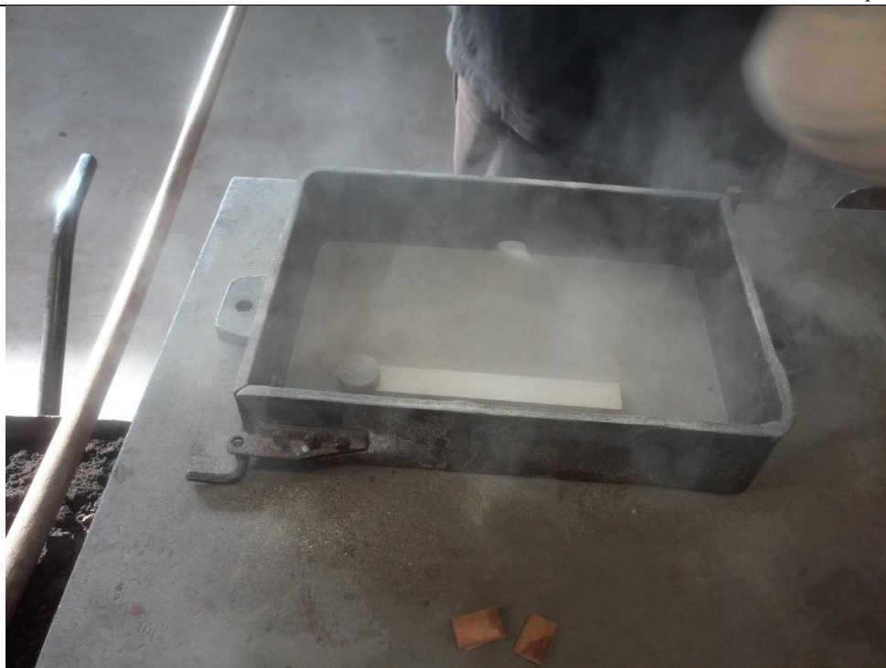
Slika 53. Donja polovica kalupa sa razdjelnikom i razvodnikom posipana likapodijem Nakon toga se u donju polovicu kalupa stavlja modelna kalupna mješavina a zatim se nakon sabijanja nanosi punidbena kalupna mješavina.
