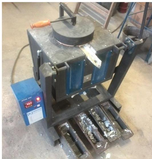
Slika 64. Elektrootporna peć
