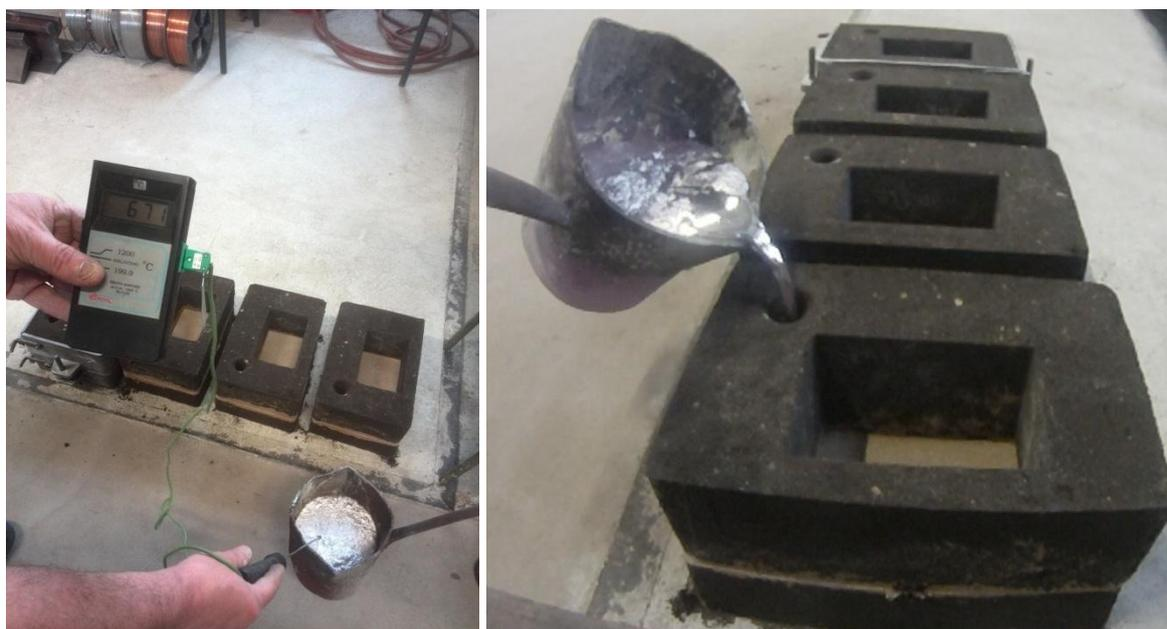
**Slika 67. Mjerenje temperature kod kalupa i ulijevanje**
