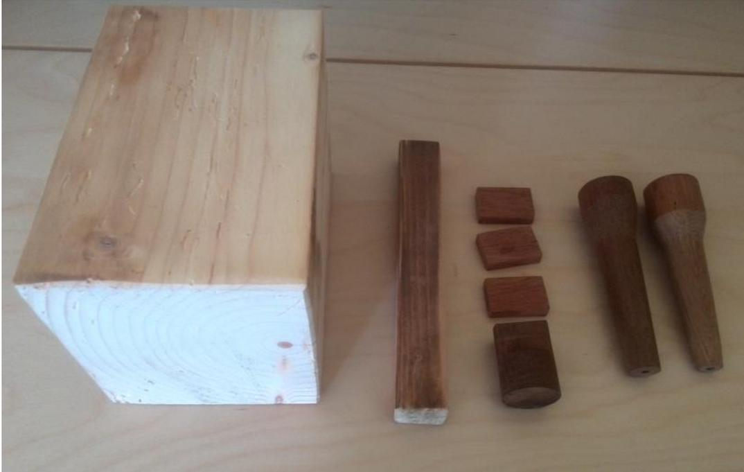
**Slika 52. Modeli uljevnog sustava 1:4:4**
