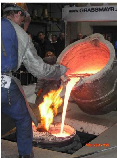
Slika 1. Lijevanje metala u kalup [2]
