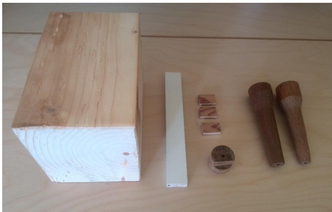
Slika 51. Modeli uljevnog sustava 1:2:2
