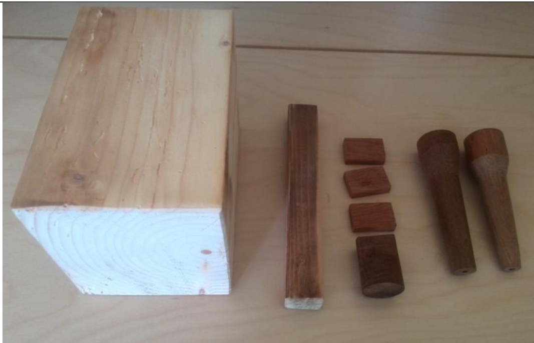
Slika 52. Modeli uljevnog sustava 1:4:4
