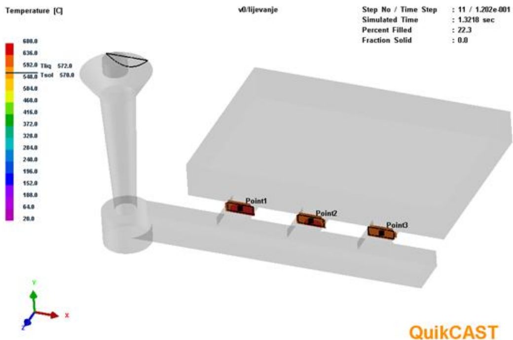
Slika 42. Karakteristični presjeci semitlačnog uljavnog sustava 1:2:2 na kojima su izvršena mjerenja brzine taljevine kroz pojedina ušća
