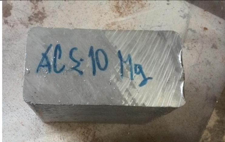
Slika 63. Ingot od legure AlSi10Mg
