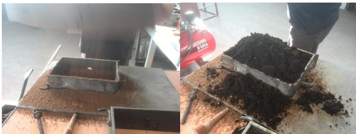
**Slika 54. Nanošenje modelne i punidbene kalupne mješavine na donjak**
