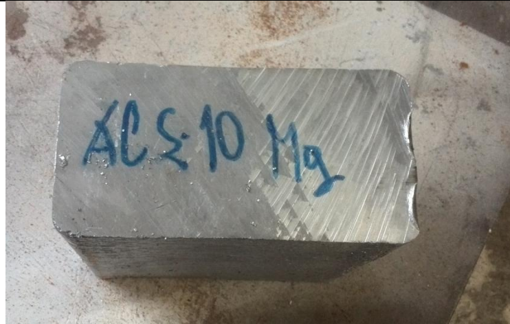
Slika 63. Ingot od legure AlSi10Mg
