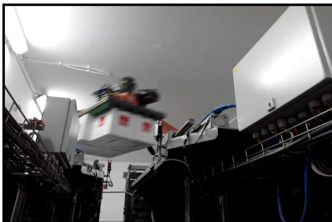
Slika 24. Franck - robot za paletiziranje, u pokretu
