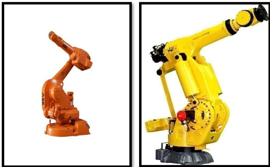
Slika 35. Primjer robotskih ruka za industriju - IRB 140 (lijevo), M900iB (desno)
