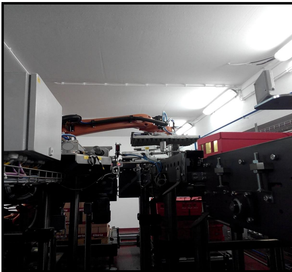
Slika 22. Franck - robot 1 za paletiziranje. Robot odjednom prenosi nekoliko kutija korištenjem pneumatske hvataljke
