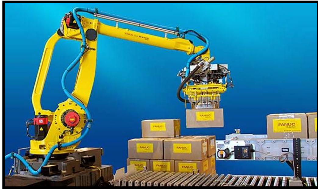
Slika 37. Primjer robota za paletizaciju - M410iB
