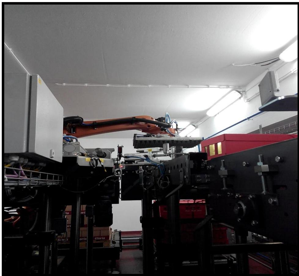
**Slika 22. Franck - robot 1 za paletiziranje. Robot odjednom prenosi nekoliko kutija korištenjem pneumatske hvataljke**
