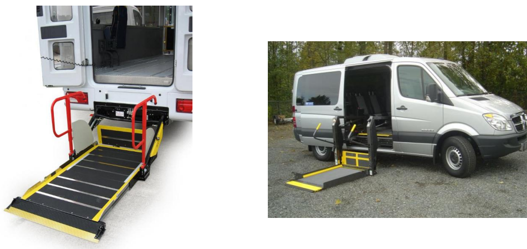
Slika 8. Vrste ukrcajnih rampi u ovisnosti o položaju rada
