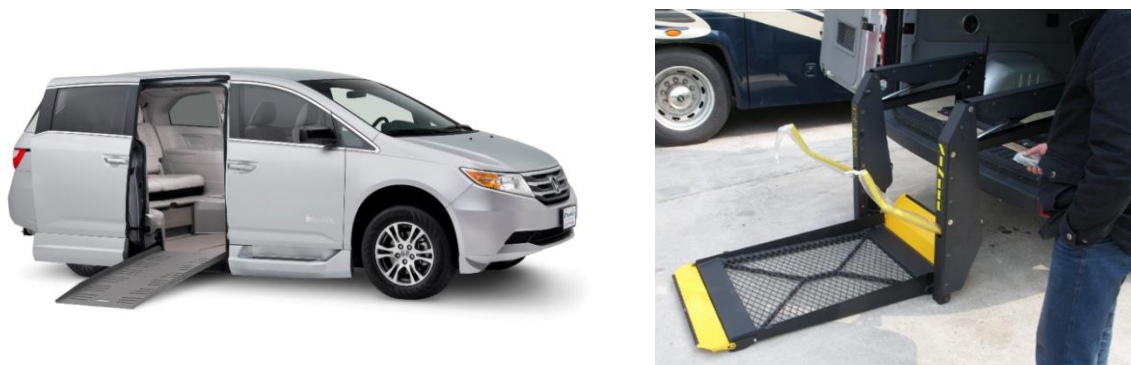
Slika 7. Vrste ukrcajnih rampi s obzirom na pogon
