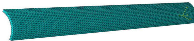
Slika 3.12: Cijev diskretizirana hibridnim tetraedarskim konačnim elementima
